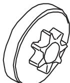
Ellenőrizze rendszeresen a meghajtókerék kopásának mértékét. Túlzott kopás esetén cserélje ki azt. Amikor láncot cserél, mindenkor cserélje ki a meghajtókeréket.
