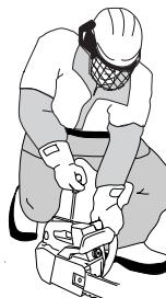
Jakmile motor naskočí (uslyšíte „bafnutí“), zamáčkněte tlačítko sytiče. Dúrazně tahejte za startovací šňůru, dokud motor nenastartuje. Po nastartování motoru rychle přidejte
