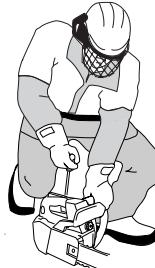
Wciśnij dźwignię ssania jak tylko silnik zostanie uruchomiony, czego sygnałem będzie słyszalny dźwięk „puff”. Powtarzaj silne pociąganie linki do momentu uruchomienia silnika. Po uruchomieniu silnika, bezzwłocznie docisnij dźwignię gazu do
