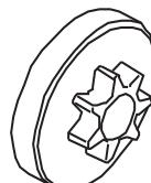
Sprawdzaj regularnie stopień zużycia zębatki napędowej łańcucha. Wymień ją, jeśli jest znacznie zużyta. Zębatkę napędową łańcucha należy wymieniać przy każdej wymianie łańcucha pilarki.
