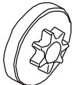
Tarkasta säännöllisesti ketjupyörän kuluneisuus. Vaihda, jos se on epätavallisen kulunut. Ketjupyörä on vaihdettava aina teräketjun vaihdona yhteydessä.
