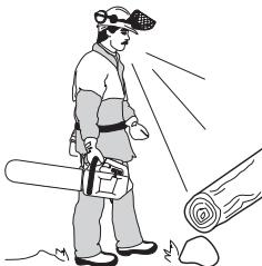
handtagen. Alla användare oavsett vänster- eller höger-fattade, ska använda detta grepp. Genom detta grepp kan du bäst reducera effekten av ett kast och samtidigt behålla kontrollen över motorsågen.
