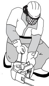
Trykk ned chokeregulatoren umiddelbart når motoren tenner, noe som høres ved en "poff"-lyd. Fortsett å dra med hurtige rykk i linen til motoren starter. Når motoren
