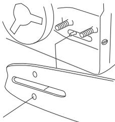
Verigo napnite s kombiniranim ključem tako, da obračate vijak za napenjanje verige v smeri urinega kazalca. Verigo napenjajte toliko časa, da ne bo več ohlapno visela s spodnjega roba meča.
