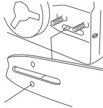
Die Kette durch Drehen der Kettenspannschraube im Uhrzeigersinn (einen Kombischlüssel verwenden) spannen. Die Kette soll gespannt werden, bis sie auf der Schienenunterseite nicht mehr durchhängt.
