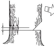
Die Rindenstütze (falls montiert) hinter dem Brechmaß ansetzen. Mit Vollgas sägen und mit der Sägekette/Führungsschiene langsam in den Baumstamm schneiden. Aufpassen, ob sich der Baumstamm entgegengesetzt zur Fällrichtung bewegt. Einen Fällkeil oder einen Fällheber in den Fällschnitt schieben, sobald die Schnitttiefe dies gestattet.
