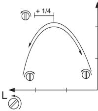
**ACHTUNG!** Wenn sich die Kette im Leerlauf dreht, ist die Schraube T gegen den Uhrzeigersinn zu schrauben, bis die Kette sich nicht mehr bewegt.
