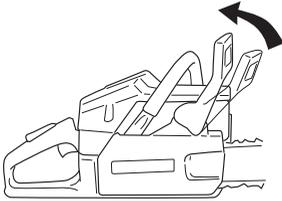
Die Schienenmuttern lösen und den Kupplungsdeckel (Kettenbremse) abnehmen. Den Transportschutz (A) entfernen.
