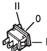
In Stellung "0" ist der Schalter abgeschaltet. Er liefert Strom an die Griffheizung in Stellung "I", an die Vergaserheizung in Stellung "II".
