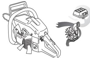
**WICHTIG!** Um die Funktion der Zentrifugalreinigung aufrecht zu erhalten, muss diese regelmäßig gewartet und gepflegt werden. Den Luftereinlass der Startvorrichtung, die Gebläseflügel des Schwungrads, den Raum um das Schwungrad, das Ansaugrohr und den Vergaserraum reinigen.
