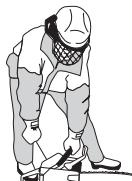
Tryk chokeren ind, så snart motoren tænder, og gør nye forsøg, indtil motoren starter. Når motoren starter, gives hurtigt fuld gas, og startgassen kobles automatisk fra.
