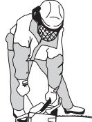
Trykk inn choken umiddelbart når motoren tenner og gjør flere startforsøk til motoren starter. Når motoren starter gir du raskt full gass, og startgassen koples ut automatiskt.
