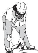
Tryck in chokereglaget omedelbart när motorn tänds och gör förynade startförsök tills motorn startar. När motorn startar, ge snabb fullgas och startgasen kopplas automatiskt ur.
