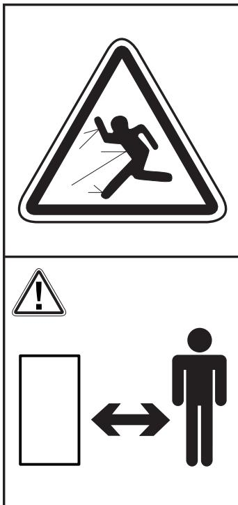
Halten Sie sich nicht im Arbeitsbereich der Kehrmaschine auf. Er entspricht einem Radius von 10 m.
