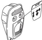
På lyddempere uten katalysator bør nettet rengjøres og eventuelt byttes en gang pr. uke. På katalysatorlyddempere skal nettet kontrolleres og eventuelt rengjøres en gang pr. måned. **Ved ev. skader på nettet skal det skiftes ut.**
