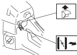
**Bränslepump:** Om maskinen är utrustad med en bränslepump (A): Tryck på bränslepumpens gummiblåsa upprepade gånger tills bränsle börjar fylla blåsan. Blåsan behöver ej fyllas helt.
