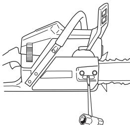
Ketjun kireys on oikea, kun se ei roiku löysällä terälevyn alapuolella ja liikkuu kevyesti käsin pyöritetäessä. Kiristä terämutterit yhdistelmäävaimella pitäen samalla terälevyn kärkeä ylhäällä.
