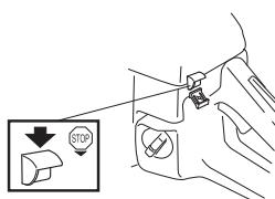
Motoren standses ved at anbringe stopknappen i stopstilling.
