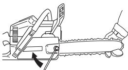
På et nytt kjede må kjedespenningen kontrolleres ofte til kjedet er kjørt inn. Kontroller kjedespenningen regelmessig. Riktig kjede betyr god skjærekapasitet og lang levetid.
