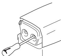
Noen lyddempere er utstyr med et spesielt gnistfangernett. Hvis maskinen er utstyr med en slik lyddemper, bør nettet rengjøres en gang i uken. Dette gjøres enklest med en stålborste. Et tilstoppet nett fører til at motoren går varm med alvorlig motorskade som følge.
