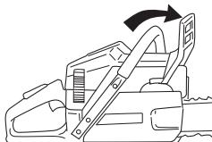
**Tænding; choker:** Sæt chokeren i chokerstilling. Stopkontakten indstilles herefter automatisk til startposition.
