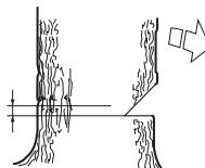
Placer barkstøtten (hvis den er monteret) bag brudpunktet. Sav med fuld gas, og før savkæden/sværdet langsomt ind i træet. Vær opmærksom på, om træet bevæger sig i modsat retning i forhold til den valgte faldretning. Sæt en fældekile i eller et brækjern i fældesnittet, så snitdybden tillader det.
