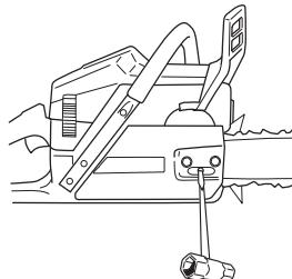
Kæden er korrekt spændt, når den ikke hænger slapt ned på sværdets underside og stadig kan trækkes rundt med hånden. Spænd sværdmøtrikkerne fast med kombinøglen, samtidig med at sværdspidsen holdes opad.
