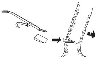
Vi anbefaler at bruge en sværdlængde, som er længere end træets diameter, så fælde- og retningssnit kan udføres med et såkaldt 'enkelt savsnit'. Se anvisningerne i afsnittet Tekniske data for at få oplysninger om, hvilke sværdlængder der anbefales til din motorsavsmodel.
