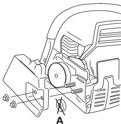
Asenna terälevy teräpultteihin. Aseta terälevy takimaiseen asentoonsa. Aseta ketju ketjupyörälle ja terälevyn ohjausuraan. Aloita terälevyn yläpuolelta.
