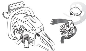
**VIGTIGT!** For at bevare centrifugalrensningens funktion skal man udføre kontinuerlig pleje og vedligeholdelse. Rens startaggregatets luftindtag, svinghjulets ventilatorflanger, området omkring svinghjulet, indsugningsrøret og karburatorrummet.
