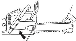
Uuden ketjun kireys on tarkastettava usein ketjun sisäänajon aikana. Tarkasta ketjun kireys säädöllisesti. Oikein kiristetty ketju takaa hyvän leikkuutehon ja pitkän kestoisen.
