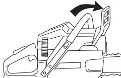
**Tenning; choke:** Still chokeshendelen i chokesetting. Stoppbryteren skal da stilles automatisk på startposisjon.
