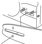
Spænd kæden ved at bruge kombinøglen til at skru kædestrammerskruen med uret. Kæden skal strammes til, så den ikke hænger slapt ned på sværdets underside. Se anvisningerne i afsnittet **Stramning af savkæden**.
