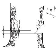
Sätt i barkstödet (om något är påmonterat) bakom brytmånen. Såga med fullgas och för sågkedjan/svärdet sakta in i trädet. Var observant på om trädet rör sig i motsatt riktning till vald fallriktning. Sätt i en fällkil eller ett brytjärn i fällskäret så snart skärdjupet tillåter.
