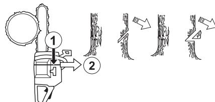
Retningssnittdybden skal være 1/4 af stammens diameter, og vinklen mellem over- og undersnit skal være mindst 45°.
