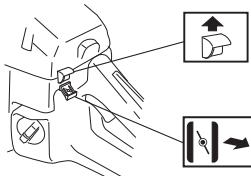
**Brændstofpumpe:** Hvis maskinen er forsynet med brændstofpumpe (A): Tryk flere gange på brændstofpumpens gummidækse, indtil blæren fyldes med brændstof. Det er ikke nødvendigt at fylde blæren helt.
