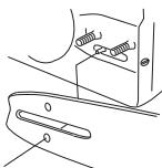
Spänn kedjan genom att med hjälp av kombinyckeln skruva kedjespännskruven medurs. Se anvisningar under rubrik Sträckning av sågkedjan.
