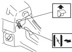
**Brennstoffpumpe:** Hvis maskinen har drivstoffpumpe (A): Trykk på brennstoffpumpens gummiblære gjentatte ganger til brennstoff begynner å fylle blæren. Blæren behøver ikke å fylles helt.
