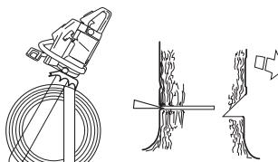
Hovedskåret skal avsluttes parallelt med styreskårlinjen slik at avstanden mellom dem er minst 1/10 av stammens diameter. Den delen av stammen som ikke er gjennomsagd, kalles brytekant.
