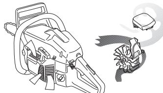
**VIGTIG!** For å opprettholde centrifugalrensingens funksjon, må den rengjøres og vedlikeholdes kontinuerlig. Rengjør luftinntaket til startmotoren, vifteskovlene på svingskjulet, rommet rundt svingskjulet, inntaksrøret og forgasserrømmet.
