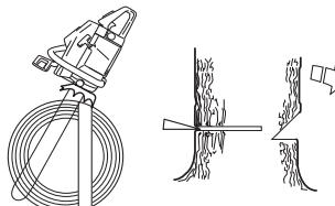
Fældesnittet skal afsluttes parallelt med retningsnitlinjen, så afstanden mellem de to er mindst 1/10 af stammens diameter. Den ikke gennemsavede del af stammen kaldes brudpunktet.
