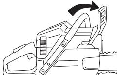
**Tändning; choke:** Ställ chokereglaget i chokeläge. Stoppkontakten skall då automatiskt ställas i startposition.
