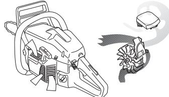
**TÄRKEÄÄ!** Keskipakoispuhdistuksen tehon säilyttämiseksi on huolehdittava säänöllisestä huollossa. Puhdista käynnistimen ilmanottoaukot, vauhtipyörän tuuletinsiivet, vauhtipyörän ympäristö, imuputki ja kaasutintila.
