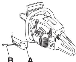
Disse reduserer kjøleluften og hindrer at større mengder snø suges inn i forgasserrrommet.
