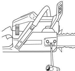
Kedjan är korrekt spänd när den inte hänger slak på svärdets undersida och fortfarande kan dras runt lätt för hand. Drag fast svärdsmuttrarna med kombinyckeln samtidigt som svärdsspetsen hålls upp.
