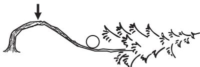
Ocenite, kako je napetost mogoče sprostiti na najbolj varen način in če boste tej nalogi lahko kos osebno. V zapletenih primerih je možen en sam varen način dela: odložite motorno žago in uporabite vitel.
