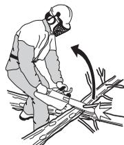
Nadzorujte delovni predmet. Če so delčki, ki jih želite rezati majhni in lahki se lahko zagozdijo v verigo in jih vrže proti vam. Čeprav to ne pomeni nevarnosti se lahko presenetite in izgubite nadzor nad žago. Nikoli ne žagajte
