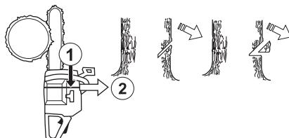
Retningssnitdybden skal være 1/4 af stammens diameter, og vinklen mellem over- og undersnit skal være mindst 45°.
