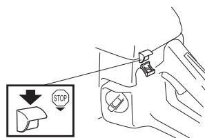
Motoren standses ved at anbringe stopknappen i stopstilling.
