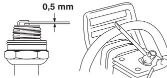
Bemerk! Bruk alltid anbefalt type tennplugg! Feil tennplugg kan ødelegge stempel/sylinder. Påse at tennpluggen har såkalt radiostøyfilter.
