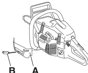
Disse reducerer køeluften og forhindrer, at større mængder sne kan suges ind i karburatorrummet.
