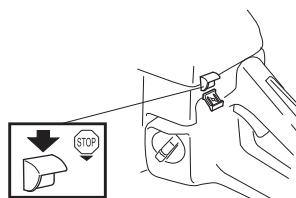
Motorn stannas genom att skjuta stoppkontakten till stoppläge.
