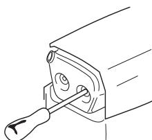
Visse lyddæmpere er udstyret med et specielt gnistfangernet. Hvis din maskine er udstyret med en sådan lyddæmper, bør nettet rengøres en gang om ugen. Dette gøres bedst med en stålborste. Et tilstoppet net medfører, at motoren kører varm med alvorlig motorskade til følge.
