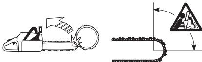
Att såga med svärdets undersida, dvs. att såga från sågobjektets ovansida och ner, kallas att såga med dragande sågkedja. Då dras motorsågen mot trädet och motorsågkroppens framkant blir ett naturligt stöd mot stammen. Sågning med dragande sågkedja ger användaren bättre kontroll över motorsågen samt över var svärdets kastrisksektor befinner sig.
