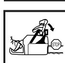
VARNING! Kast kan uppstå när svärdsspetsen kommer i kontakt med ett föremål och orsakar en reaktion som kastar svärdet uppåt och bakåt mot användaren. Detta kan orsaka allvarlig personlig skada.
