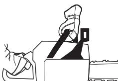
Gi full gass og aktiver kjedebremsen ved å vri venstre håndledd mot kastbeskyttelsen. Ikke slipp det fremste håndtaket. **Kjedet skal stanse umiddelbart.**
