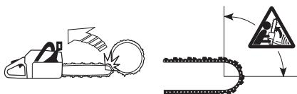
Å sage med sverdets underside, dvs. å sage fra sagobjektets overside og ned, kalles å sage med dragende sagkjede. Da dras motorsagen mot treet, og motorsagkroppens forkant blir en naturlig støtte mot stammen. Saging med dragende sagkjede gir brukeren bedre kontroll over motorsagen og over hvor sverdets kastriskosektor befinner seg.
