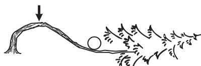
Avgör hur du säkrast frigör spänningen och om du klarar av att göra det. Vid extra komplicerade situationer är den enda säkra metoden att avstå från motorsågsanvändning och använda en vinsch.
