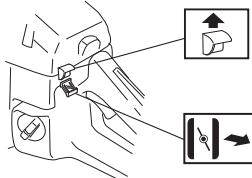
Om maskinen är utrustad med en dekompressionsventil (A): Tryck in ventilen för att minska trycket i cylindern, detta för att underlätta starten av maskinen.
