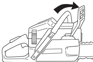
**Tenning; choke:** Still chokehendelen i chokestilling. Stoppbryteren skal da stilles automatisk på startposisjon.
