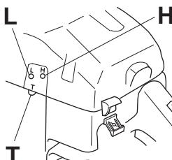
Med L- och H-munstyckena justeras önskad bränslemängd till det luftflöde som gasreglagets öppning medger. Skruvas de medurs blir luft/bränsleblandningen mager (mindre bränsle) och skruvas de moturs blir luft/bränsleblandningen fet (mer bränsle). Mager blandning ger högre varvtal och fet blandning ger lägre varvtal.
