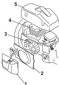
Rengjør kjølesystemet med en børste en gang i uken, ved vanskelige forhold oftere. Et tilsmusset eller tett kjølesystem fører til at maskinen overoppphetes, noe som forårsaker skader på sylinder og stempel.
