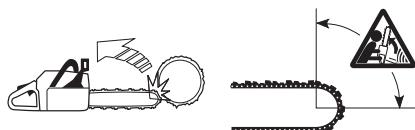
At save med sværdets underside, dvs. save fra objektets overside og ned, kaldes at save med trækende savkæde. Da trækkes motorsaven mod træet og motorsavskroppens forkant bliver en naturlig støtte mod stammen. Savning med trækende savkæde giver brugeren bedre kontrol over motorsaven, og man ved, hvor sværdets kastriskoområde befinner sig.
