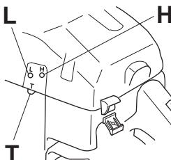
Med L- og H-mundstykkerne justeres den ønskede brændstofmængde til den luftstrøm, som kommer fra gasreguleringens åbning. Skrues de med uret bliver luft/brændstofblandingen mager (mindre brændstof), og skrues de mod uret bliver brændstofblandingen fed (mere brændstof). Mager blanding giver et højere omdrejningstal, og fed blanding giver et lavere omdrejningstal.
