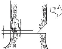
Sätt i barkstödet (om något är påmonterat) bakom brytmånen. Såga med fullgas och för sågkedjan/svärdet
