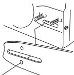
Spänn kedjan genom att med hjälp av kombinyckeln skruva kedjespännskruven medurs. Se anvisningar under rubrik Sträckning av sågkedjan.
