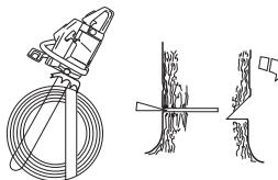
Fälchkäret skall avslutas parallellt med riktskärslinjen så att avståndet mellan de båda är minst 1/10 av stamdiometern. Den icke genomsågade delen av stammen kallas brytmån.
