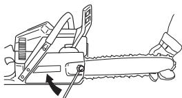
På en ny kæde skal kædestramningen kontrolleres ofte, indtil kæden er kørt til. Kontrollér kædestramningen regelmæssigt. Korrekt kæde betyder god skærekapacitet og lang levetid.
