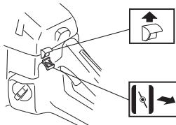
Hvis maskinen er forsynet med en dekompresionsventil (A): Tryk ventilen ind for at mindske trykket i cylinderen, så maskinen starter lettere. Dekompresionsventilen bør
