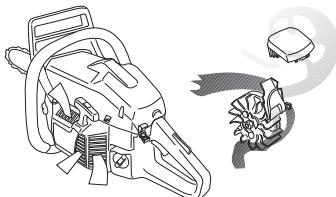
TÄRKEÄÄ! Keskipakoispuhdistuksen tehon säilyttämiseksi on huolehdittava säännöllisestä huollossa. Puhdista käynnistimen ilmanottoaukot, vauhtipyörän tuuletinsivut, vauhtipyörän ympäristö, imuputki ja kaasutintila.
