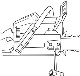
Kæden er korrekt spændt, når den ikke hænger slapt ned på sværrets underside og stadig kan trækkes rundt med hånden. Spænd sværdmøtrikkerne fast med kombinøglen, samtidig med at sværdspidsen holdes opad.
