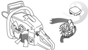
**VIGTIG!** For å opprettholde centrifugalrensings funksjon, må den rengjøres og vedlikeholdes kontinuerlig. Rengjør luftintaket til startmotoren, viftekovlene på svinghjulet, rommet rundt svinghjulet, inntaksrøret og forgasserrømmet.
