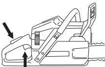
Notera! Återställ kedjebromsen genom att föra kastskyddet mot handtagsbygeln. Motorsågen är härmed klar för användning.
