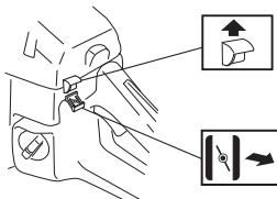
Hvis maskinen har dekompresjonsventil (A): Trykk inn ventilen for å redusere trykket i sylinderen, dette for å gjøre maskinen lettere å starte. Dekompresjonsventilen
