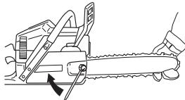
På et nytt kjede må kjedespenningen kontrolleres ofte til kjedet er kjort inn. Kontroller kjedespenningen regelmessig. Riktig kjede betyr god skjærekapasitet og lang levetid.
