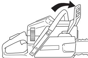
**Tändning; choke:** Ställ chokereglaget i chokeläge. Stopkontakten skall då automatiskt ställas i startposition.
