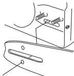
Kiristä ketju kiertämällä ketjun kiristysruuvia yhdistelmäävaimella myötpäivään. Ketjua on kiristettävä
