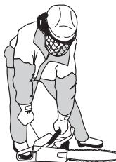
Trykk inn choken umiddelbart når motoren terner og gjør flere startforsøk til motoren starter. Når motoren starter gir du raskt full gass, og startgassen koples ut automatisk.
