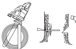
Fældesnittet skal afsluttes parallelt med retningssnitlinjen, så afstanden mellem de to er mindst 1/10 af stammens diameter. Den ikke gennemsavede del af stammen kaldes brudpunktet.
