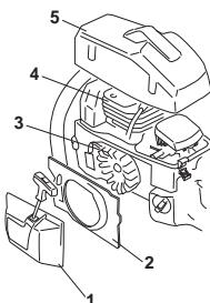
Rens kølesystemet med en børste en gang om ugen, under støvfyldte forhold oftere. Et snavset eller tilstoppet kølesystem medfører overopvarmning af maskinen med skader på cylinderen og stemplet til følge.
