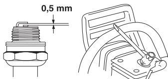
Notera! Använd alltid rekommenderad tändstiftstyp! Felaktigt tändstift kan förstöra kolv/cylinder. Se till att tändstiftet har s.k. radioavstörning.
