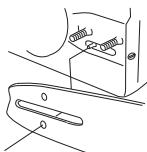
Spænd kæden ved at bruge kombinøglen til at skrure kædestrammerskruen med uret. Kæden skal strammes til, så den ikke hænger slapt ned på sværrets underside. Se anvisningerne i afsnittet Stramning af savkæden.
