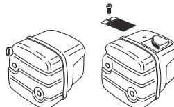
**HUOM!** Äänenvaimennin kuumentuu erittäin voimakkaasti sekä käytön aikana että pysäytämisestä jälkeen. Tämä koskee myös joutokäytäviä. Ota palonvaara huomioon, erityisesti palonarkojen aineiden ja/tai kaasujen läheisyydessä.
