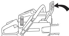
Ruuva terämutterit irti ja irrota kytkinkotelo (ketjujarru). Poista kuljetussuoja (A).
