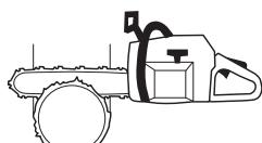
Käytössä on menetelmiä, joilla voidaan kaataa terälevyn pituitta paksumpia puita. Näitä menetelmiä käytettäessä on erittäin suuri vaara, että terälevyn takapotkusektori osuu johonkin.
