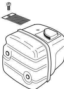
Lyddemperen er utformet for å dempe lydnivået og for å lede avgassene bort fra brukeren. Avgassene er varme og kan inneholde gnister som kan forårsake brann hvis gassene rettes mot et tørt og brennbart materiale.
