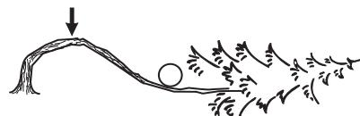
Afgør, hvordan du på den sikreste måde kan frigøre spændingen, og om du kan klare det. Ved særligt komplicerede situationer er den eneste sikre metode helt at undlade at bruge motorsaven og i stedet bruge et spil.
