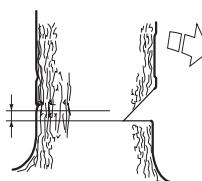
Placer barkstøtten (hvis den er monteret) bag brudpunktet. Sav med fuld gas, og før savkæden/sværdet langsomt ind i træet. Vær opmærksom på, om træet bevæger sig i modsat retning i forhold til den valgte faldretning. Sæt en fældekile i eller et brækjern i fældesnittet, så snart snitdybden tillader det.
