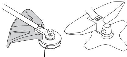
Kontrollér, at beskyttelsen er intakt og fri for revner. Udskift beskyttelsen, hvis den har været utsat for slag eller har revner.
