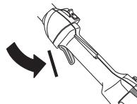
Tryck in gasreglagespärren och kontrollera att den återgår till sitt ursprungsläge när den släpps.
