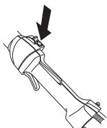
Start motoren og kontroller at motoren blir slått av når stoppbryteren føres til stoppstilling.
