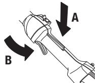
Kontrollér, at gasreguleringen er låst i tomgangsstilling, når gasreguleringslåsen befinner sig i udgangsstilling.
