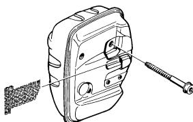
På lyddempere uten katalysator bør nettet rengjøres og eventuelt byttes en gang pr. uke. På katalysatorlyddempere skal nettet kontrolleres og eventuelt rengjøres en gang pr. måned. **Ved ev. skader på nettet skal det skiftes ut.**
