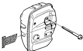
Katalysaattoritöissä äänenvaimentimissa verkko on puhdistettava ja tarvittaessa vaihdettava kerran viikossa. Katalysaattori-äänenvaimentimissa verkko on tarkastettava ja tarvittaessa puhdistettava kerran kuukaudessa. **Jos verkko on vioittunut, se on vaihdettava.**
