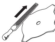
Kontrollera skärutrustningen med avseende på skador och sprickbildning. En skadad skärutrustning ska alltid bytas ut.
