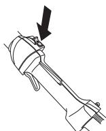
Starta motorn och kontrollera att motorn stängs av när stoppkontakten förs till stoppläget.
