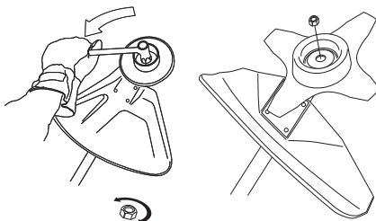
Låsemutterens nylondel må ikke være så slitt at den kan skrus med fingrene. Låsingens må holde minst 1,5 Nm. Mutteren må skiftes etter at den har vært skrudd på ca. 10 ganger.
