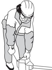
**OBS!** Placera inte någon del av kroppen på den markerade ytan. Kontakt kan resultera i brännskador på huden eller elektrisk stöt om tändhatten är defekt. Använd alltid handskar. Använd aldrig en maskin med defekt tändhatt.
