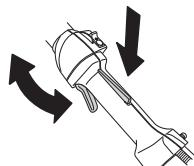
Se anvisningar under rubrik Start. Starta maskinen och ge full gas. Släpp gasreglaget och kontrollera att skärutrustningen stannar och att den förblir stillstående.
