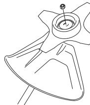
Asennettaessa, kiristä mutteri terälaitteen pyörimissuuntaa vastaan. Irrotettaessa, irrota mutteri terälaitteen pyörimissuuntaan. (HUOM! Mutterissa on vasenkäytinen kierre.) Raivausterän mutteria avattaessa ja kiristettäessä on aiheuttavat raivausterän hampaat tapaturmavaaran. Pidä sen vuoksi kätesi teränsuojuksen
