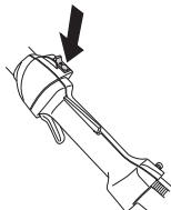
Start motoren, og kontrollér, at motoren slukkes, når stopkontakten sættes i stopposition.
