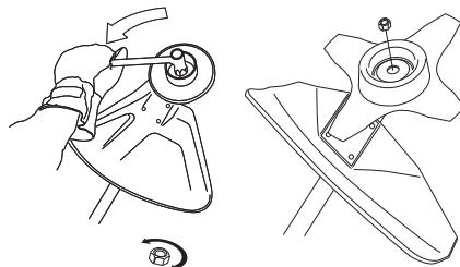
Låsmutterns nylonläsning får ej vara så sliten att den kan skruvas med fingrarna. Låsningen ska hålla minst 1,5 Nm. Muttern ska bytas efter det att den skruvats på ca 10 gånger.
