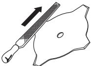
Kontroller skjæreutstyret med henblikk på skader og sprekkdannelse. Skadet skjæreutstyr må alltid skiftes.
