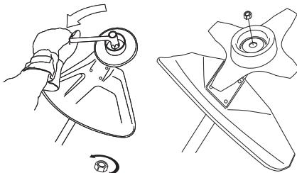
Lukitusmutterin nilonlukitus ei saa olla niin kulunut, että sitä voi ruuvata käsin. Lukitukseen on kestettävä vähintään 1,5 Nm. Mutteri on vaihdettava, kun se on ruuvattu kiinni noin 10 kertaa.
