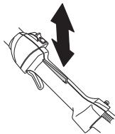
Kontroller at gassregulatoren og gassregulatorsperren går lett og at returfjærsystemet fungerer.
