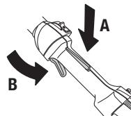
Kontrollera att gasreglaget är låst i tomgångsläge när gasreglagespärren är i sitt ursprungsläge.
