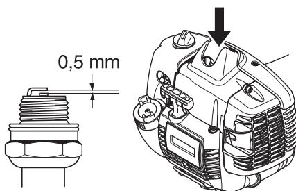
**BEMÆRK!** Brug altid anbefalet tændrørstype! Forkert tændrør kan ødelægge stempel/cylinder.
