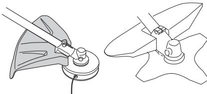
Tarkasta, että suojuks on ehjä ja ettei siinä ole halkeamia. Vaihda suojuks, jos siihen on kohdistunut iskuja tai siinä on halkeamia.
