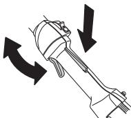
Se anvisninger under overskriften Start. Start maskinen og gi full gass. Slipp gassregulatoren og kontroller at skjæreutstyret stanser og at det blir stående stille. Hvis skjæreutstyret roterer når gassregulatoren står i tomgangsstilling må forgasserens tomgangsjustering kontrolleres. Se anvisninger under overskriften Vedlikehold.
