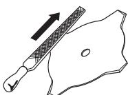
Kontrollér skæreudstyret med hensyn til skader og revnedannelse. Et beskadiget skæreudstyr skal altid udskiftes.
