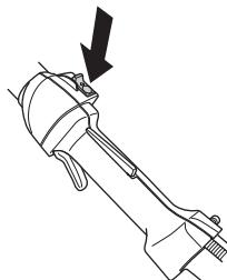
**OBS!** Stopkontakten återgår automatiskt till startläge. För att undvika ofrivillig start, måste därför alltid tändhatten avlägsnas från tändstiftet vid montering, kontroll och/eller underhåll.
