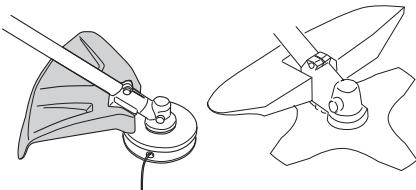
Kontroller at vernet er uskadd og fritt for sprekkdannelser. Skift vernet hvis det er blitt utsatt for slag eller har sprekker.
