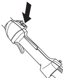
**ADVARSEL!** Når motoren startes med chokeren i choker- eller startgasstilling, begynder skæreudstyret straks at rotere.
