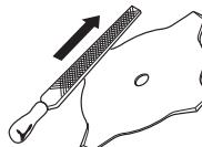
Tarkasta terälaitte vaurioiden ja halkeamien varalta. Vaurioitunut terälaitte on aina vaihdettava.
