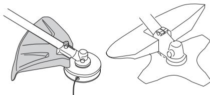
Kontrollera att skyddet är oskadat och fritt från sprickbildning. Byt skydd om det utsatts för slag eller har sprickor.
