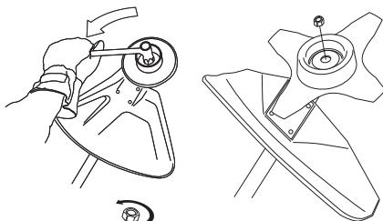
Låsemøtrikkens nylonslås må ikke være så slidt, at den kan drejes med fingrene. Låsen skal holde mindst 1,5 Nm. Møtrikken skal udskiftes, når den har været skruet på ca. 10 gange.
