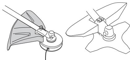
Kontroller at vernet er uskadd og fritt for sprekkdannelser. Skift vernet hvis det er blitt utsatt for slag eller har sprekker.
