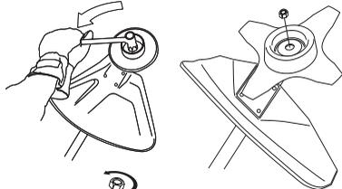
Låsmutterns nylonlåsning får ej vara så sliten att den kan skruvas med fingrarna. Låsningen ska hålla minst 1,5 Nm. Muttern ska bytas efter det att den skruvats på ca 10 gånger.
