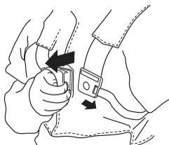
Kontrollera att selens remmar är rätt placerade. När selen och maskinen är justerade, kontrollera att selens snabbtöslösning fungerar.
