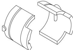
Kontrollera regelbundet avvibreringselementen efter materialsprickor och deformationer. Kontrollera att avvibreringselementen är hela och fast förankrade.
