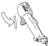
Tryck in gasreglagespärren och kontrollera att den återgår till sitt ursprungsläge när den släpps.
