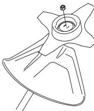
Vid montering, drag åt muttern mot skärutrustningens rotationsriktning. Vid demontering, lossa muttern i skärutrustningens rotationsriktning. (OBS! Muttern är vänstergängad.) Drag åt muttern med hylsnyckeln.
