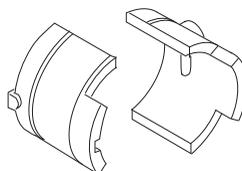
Kontrollér regelmæssigt vibrationsdæmpningselementerne for materialerevner og deformationer. Kontrollér, at vibrationsdæmpningskomponenterne er intakte og fast forankrede.
