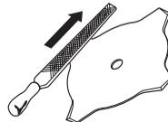
Sørg for, at udlægningen på savklingen er korrekt! Følg vores instruktioner, og brug det anbefalede udlæggerværktøj. En forkert udlagt savklinge øger
