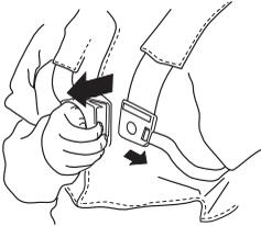
Tarkasta, että valjaiden hihnat on asetettu oikein. Kun valjaat ja kone on säädetty, tarkasta, että valjaiden pikairroin toimii.
