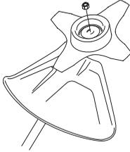
Asennettaessa, kiristä mutteri terälaitteen pyörimissuuntaa vastaan. Irrottaessa, irrota mutteri terälaitteen pyörimissuuntaan. (HUOM! Mutterissa on vasenkätinen kierre.) Kiristä mutteri hylsyavaimella.
