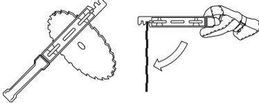
Kontroller skjæreutstyret med henblikk på skader og sprekke dannelse. Skadet skjæreutstyr må alltid skiftes.
