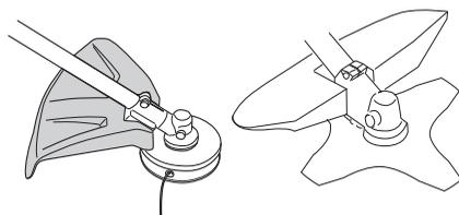
Kontrollér, at beskyttelsen er intakt og fri for revner. Udskift beskyttelsen, hvis den har været udsat for slag eller har revner.
