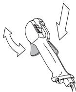
Se anvisninger under overskriften Start. Start maskinen og gi full gass. Slipp gassregulatoren og kontroller at skjæreutstyret stanser og at det blir stående stille. Hvis skjæreutstyret roterer når gassregulatoren står i tomgangsstilling må forgasserens tomgangsjustering kontrolleres. Se anvisninger under overskriften Vedlikehold.
