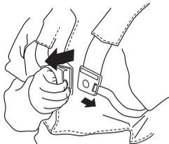
Kontrollér, at selens remme er korrekt placeret. Når selen og maskinen er justeret, skal det kontrolleres, at selens snapudløsning fungerer.
