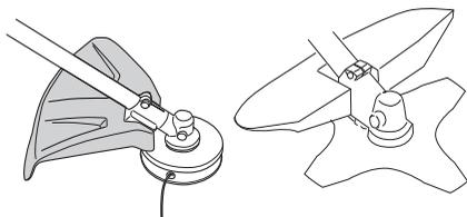
Kontrollera att skyddet är oskadat och fritt från sprickbildning. Byt skydd om det utsatts för slag eller har sprickor.
