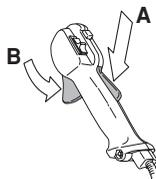
Kontroller at gassregulatoren er låst i tomgangsstilling når gassregulatorsperren er i sin utgangsposisjon.
