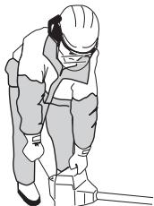
**BEMÆRK!** Anbring ikke nogen legermsdele på den markerede overflade. Kontakt kan medføre forbrændinger af huden eller elektrisk stød, hvis tændhætten er defekt. Anvend altid handsker. Anvend aldrig en maskine med defekt tændhætte.
