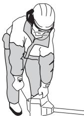
**OBS!** Ikke plasser noen del av kroppen på den markerte flaten. Berøring kan medføre brannskader på huden eller elektrisk støt dersom tennpluggen er defekt. Bruk alltid hanske. Bruk aldri en maskin med defekt tennplughette.
