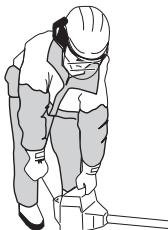
**OBS!** Placer inte någon del av kroppen på den markerade ytan. Kontakt kan resultera i brännskador på huden eller elektrisk stöt om tändhatten är defekt. Använd alltid handskar. Använd aldrig en maskin med defekt tändhatt.
