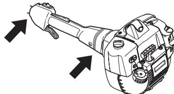
Wenn der Faden falsch gewickelt ist oder die falsche Schneidausrüstung benutzt wird, verstärken sich die Vibrationen. Siehe die Anweisungen unter der Überschrift Schneidausrüstung.
