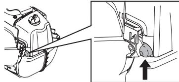
**Choke:** Den Chokehebel in Choke-Lage führen.
