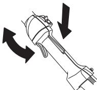
Glej poglavje pod naslovom Vžig. Vžgite stroj in mu dajte polni plin. Izpustite plinsko ročico in se prepričajte, da se rezilni priključek ustavi in obmiruje. Če se rezilni priključek vrti, ko je plinska ročica v legi prostega teka, preglejte nastavitve uplinjača v prosti legi. Glejte navodila v poglavju Vzdrževanje.
