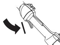
Tryck in gasreglagespärren och kontrollera att den återgår till sitt ursprungsläge när den släpps.
