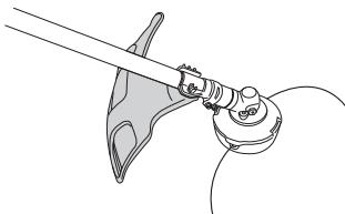
Tarkasta, että suojuS on ehjä ja ettei siinä ole halkeamia. Vaihda suojuS, jos siihen on kohdistunut iskuja tai siinä on halkeamia.
