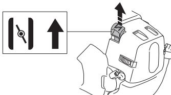
**Bränslepump:** Tryck på bränslepumpens gummibläsa uppreatade gånger tills bränsle börjar fylla blåsan. Blåsan behöver ej fyllas helt.
