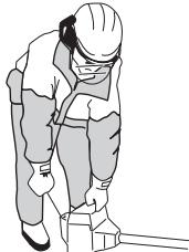
**OBS!** Ikke plasser noen del av kroppen på den markerte flaten. Berøring kan medføre brannskader på huden eller elektrisk støt dersom tennplughetten er defekt. Bruk alltid hansker. Bruk aldri en maskin med defekt tennplughette.
