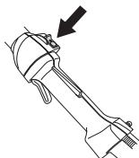
**HUOM!** Pysäytyskosketin palautuu automaattisesti käynnistysasentoon. Sen vuoksi, tähattoman käynnistyksen estämiseksi, sytytystulpansuojuksen on aina irrotettava sytytystulpasta asennuksen, tarkastuksen ja/ tai huollon ajaksi.
