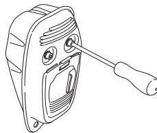
Är din maskins ljuddämpare utrustad med ett gnistfängarnät, skall detta rengöras regelbundet. Ett igaensatt nät leder till varmkörning av motorn med allvarlig motorskada som följd.
