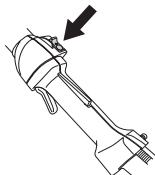
**OBS!** Stoppkontakten återgår automatiskt till startläge. För att undvika ofrivillig start, måste därför alltid tändhatten avlägsnas från tändstiftet vid montering, kontroll och/eller underhåll.
