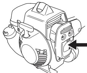
Noen lyddempere er utstyrt med et spesielt gnistfangernett. Hvis maskinen er utstyrt med en slik lyddemper, bør nettet rengjøres en gang i uken. Dette gjøres enklest med en stålborste. På lyddempere uten katalysator bør nettet rengjøres og eventuelt byttes en gang pr. uke. På katalysatorlyddempere skal nettet
