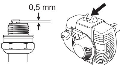
**OBS!** Använd alltid rekommenderad tändstiftstyp! Felaktigt tändstift kan förstöra kolv/cylinder. Se till att tändstiften har s.k. radioavstörning.
