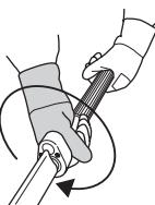
**N.B.!** Wanneer u voorbij de stopstand bent, zijn de messen geblokkeerd, probeer niet te knippen als het snij-aggregaat in deze stand staat.
