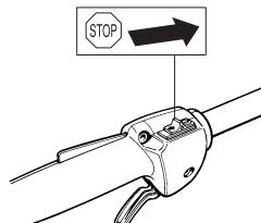
**ACHTUNG!** Der Stoppschalter geht automatisch in die Startstellung zurück. Um ein ungewolltes Starten zu vermeiden, muss bei Montage, Kontrolle und/oder Wartung daher stets die Zündkappe von der Zündkerze entfernt werden.
