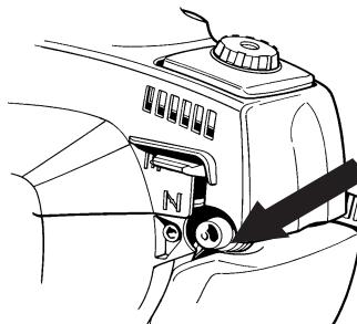
**Choke:** Den Chokehebel in Choke-Lage führen.
