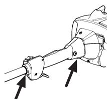
Das Antivibrationssystem reduziert die Übertragung von Vibrationen zwischen Motoreinheit/Schneidausrüstung und dem Griffsystem des Gerätes.
