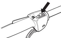
Start de motor en controleer of de motor wordt uitgeschakeld wanneer de stopschakelaar in de stopstand wordt gezet.
