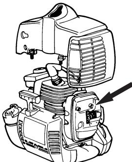
Bepaalde geluiddempers zijn voorzien van een speciaal vonkenopvangnet. Indien uw machine uitgerust is met zo'n geluiddemper, moet u het net minstens één keer per week schoonmaken. Gebruik bij voorkeur een stalen borstel.
