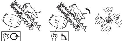
Lorsque les lames sont réglées correctement, un jeu de 0,2-0,4 mm entre les lames doit pouvoir être mesuré au niveau des vis.
