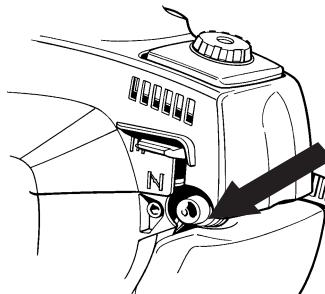
**Choke:** Zet de choke-hendel in de choke-positie.
