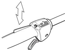
Kontrollieren, ob Gashebel und Gashebelsperre mit dem dazugehörigen Rückzugfederungssystem leicht funktionieren.
