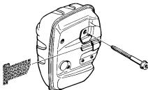
Bei Schalldämpfern ohne Katalysator sollte das Netz einmal in der Woche gereinigt und ggf. ausgetauscht werden. Bei Katalysatorschalldämpfern ist das Netz einmal im Monat zu kontrollieren und evtl. zu reinigen.
