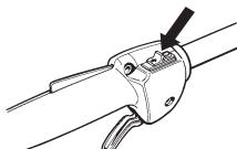
Den Motor starten und kontrollieren, ob der Motor stoppt, wenn der Stoppschalter in Stoppstellung geführt wird.
