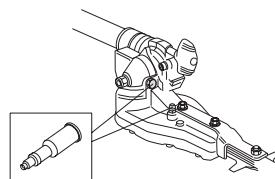
**N.B.!** De versnelling moet niet helemaal met vet gevuld worden. Het vet expandeert door de warmte die ontstaat als de machine loopt. Mocht de versnelling helemaal gevuld zijn met vet bestaat het risico van kapotteafdichtingen en lekkage van vet.
