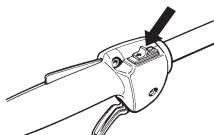
Mettre le moteur en marche et s'assurer qu'il s'arrête lorsque le bouton d'arrêt est amené en position d'arrêt.
