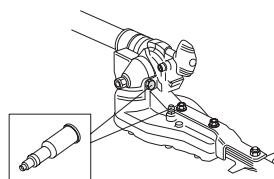
**ACHTUNG!** Das Getriebe darf nicht ganz mit Fett gefüllt werden. Das Fett dehnt sich durch die beim Betrieb des Gerätes entstehende Wärme aus. Ist das Getriebe ganz voll Fett, besteht die Gefahr, dass Dichtungen zerstört werden und Fett austritt.
