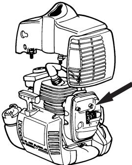
Bestimmte Schalldämpfer sind mit einem speziellen Funkenfangnetz ausgerüstet. Ist Ihr Gerät mit einem derartigen Schalldämpfer ausgestattet, so ist das Netz einmal wöchentlich zu säubern. Dies geschieht am besten mit einer Stahlbürste.
