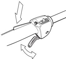
Zie de aanwijzingen in het hoofdstuk Start. Start de heggenschaar en geef vol gas. Laat de gashendel los en controleer of de messen stoppen en stil blijven staan. Als de messen bewegen wanneer de gashendel in stationairstand staat, moet het stationair toerental van de carburateur afgesteld worden. Zie de aanwijzingen in het hoofdstuk Onderhoud.
