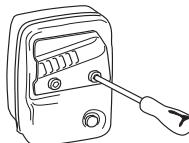
Ist der Schalldämpfer Ihres Gerätes mit einem Funkenfangnetz versehen, muss dieses regelmäßig gereinigt werden. Ein verstopftes Netz verursacht ein Heißlaufen des Motors mit schweren Motorschäden als Folge.
