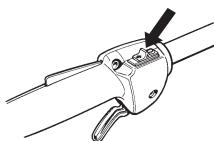
Starta motorn och kontrollera att motorn stängs av när stoppkontakten förs till stoppläget.
