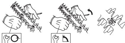
Ved korrekt justerede knive skal der, målt ved skruerne, være et spil mellem knivene på 0,2-0,4 mm.
