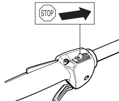
**HUOM!** Pysäytyskosketin palautuu automaattisesti käynnistysasentoon. Sen vuoksi, tahattoman käynnistysken estämiseksi, sytytystulpan suojuus on aina irrotettava sytytystulpasta asennuksen, tarkastuksen ja/ tai huollon ajaksi.
