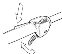
Se anvisningar under rubrik Start. Starta häcksaxen och ge full gas. Släpp gasreglaget och kontrollera att knivarna stannar och förblir stillstående. Om knivarna rör sig med gasreglaget i tomgångsläge skall förgasarens tomgång justeras. Se anvisningar under rubrik Underhåll.
