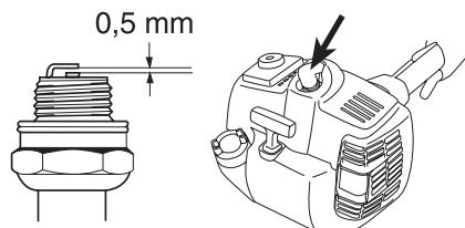
**OBS!** Bruk alltid anbefalt type tennplugg! Feil tennplugg kan ødelegge stempel/sylinder. Påse at tennpluggen har såkalt radiostøyfilter.
