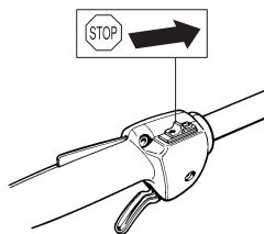
**BEMÆRK!** Stopkontakten skifter automatisk til startposition. For at undgå utilsigtet start skal tændhætten derfor altid tages af tændrøret ved montering, kontrol og/eller vedligeholdelse.
