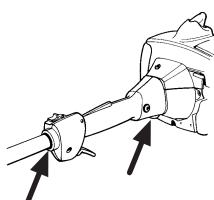
Maskinens avvibreringssystem reduserer overføringen av vibrasjoner mellom motorenhet/skjæreutstyr og maskinens håndtak.
