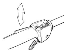
Kontroller at gassregulatoren og gassregulatorsperren går lett og at returfjærssystemet fungerer.
