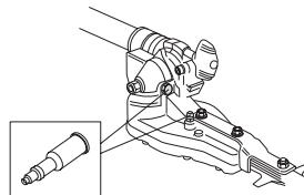
**BEMÆRK!** Gearet skal ikke fyldes helt med fedt. Fedtet udvides af den varme, som opstår, når maskinen kører. Hvis gearet var helt fyldt med fedt, er der risiko for ødelagte pakninger og fedtlækage.
