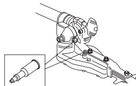
**HUOM!** Vaihdeita ei saa täyttää aivan täyneen rasvalla. Rasva laajenee koneen käytön aikana kehittyvän lämmön vaikutuksesta. Jos vaihde on aivan täynnä rasvaa, on olemassa tiivisteiden vaurioitumisen ja rasvavuodon vaaraa.
