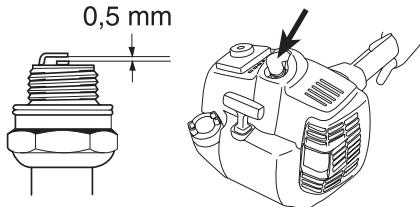
**OBS!** Använd alltid rekommenderad tändstiftstyp! Felaktigt tändstift kan förstöra kolv/cylinder. Se till att tändstiften har s.k. radioavstörning.
