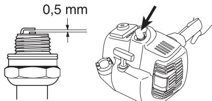
**BEMÆRK!** Brug altid anbefalet tændrørstype! Forkert tændrør kan ødelægge stempel/cylinder. Kontrollér, at tændrøret har såkaldt radiostøjdæmpning.
