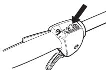
Start motoren, og kontrollér, at motoren slukkes, når stopkontakten sættes i stopposition.
