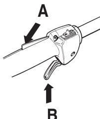
Kontrollér, at gasreguleringen er låst i tomgangsstilling, når gasreguleringslåsen befinner sig i udgangsstilling.
