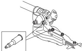
**OBS!** Växeln ska ej fyllas helt med fett. Fettet expanderas av den värme som uppstår när maskinen körs. Skulle växeln vara helt fylld med fett finns det risk för förstörda tätningar och fettläckage.
