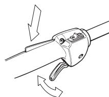
Se anvisningerne under overskriften Start. Start hækkeklipperen, og giv fuld gas. Slip gasreguleringen, og kontrollér, at knivene standser, og at de bliver stående stille. Hvis knivene bevæger sig med gasreguleringen i tomgangsstilling, skal karburatorens tomgangsindstilling justeres. Se anvisningerne under overskriften Vedligeholdelse.
