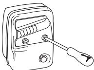
Är din maskins ljuddämpare utrustad med ett gnistfångarnät, skall detta rengöras regelbundet. Ett igensatt nät leder till varmkörning av motorn med allvarlig motorskada som följd.
