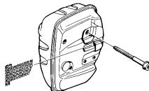
På ljuddämpare utan katalysator bör nätet rengöras och eventuellt bytas en gång per vecka. På katalysatorljuddämpare skall nätet kontrolleras och eventuellt rengöras en gång per månad. **Vid ev. skador på nätet skall detta bytas.** Om näten ofta är igensatt, kan detta vara ett tecken på att katalysatorns funktion är nedslatt. Kontakta din återförsäljare för kontroll. Med ett igensatt nät överhettas maskinen med skador på cylinder och kolv som följd.
