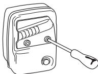
Hvis lyddemperen i maskinen er utstyrt med gnistfangernett, må dette rengjøres regelmessig. Et tilstoppet nett fører til at motoren går varm med alvorlig motorskade som følge.
