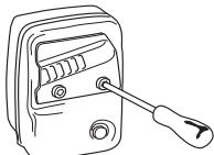
Jos koneesi äänenvaimennin on varustettu kipinänsammatusverkolla, on myös se puhdistettava säännöllisesti. Tukkeutunut verkko aiheuttaa moottorin kuumentemisen, mistä seuraa vakava moottorivaurio.
