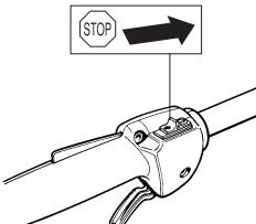
**OBS!** Stoppkontakten återgår automatiskt till startläge. För att undvika ofrivillig start, måste därför alltid tändhatten avlägsnas från tändstiftet vid montering, kontroll och/eller underhåll.
