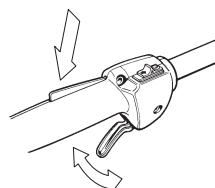
Se anvisninger under Start. Start hekksaksen og gi full gass. Slipp gassregulatoren og kontroller at knivene stanser og forblir stående stille. Hvis knivene beveger seg når gassregulatoren står i tomgangsstilling, må forgasserens tomgang kontrolleres. Se anvisninger under Vedlikehold.
