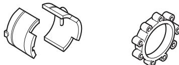
Tarkasta säännöllisesti, ettei vaimentimissa ole halkeamia tai vääräntymiä. Tarkasta, että tärinänvaimennuselementit ovat ehjät ja kunnolla kiinni.
