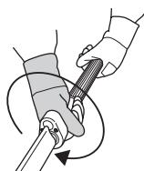
**BEMÆRK!** Når stoppet er passeret, er knivene blokeret; forsøg ikke at klippe med klippeaggregatet i denne position.
