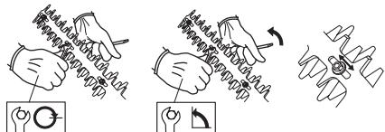
Ved korrekt justerte kniver skal det, målt ved skruene, være en klaring mellom knivene på 0,2-0,4 mm.
