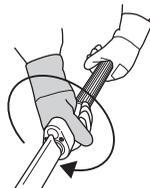
**ACHTUNG!** Bei überschrittener Stopposition sind die Messer blockiert; bitte nicht versuchen, mit dem Schneidwerk in dieser Position zu mähen.
