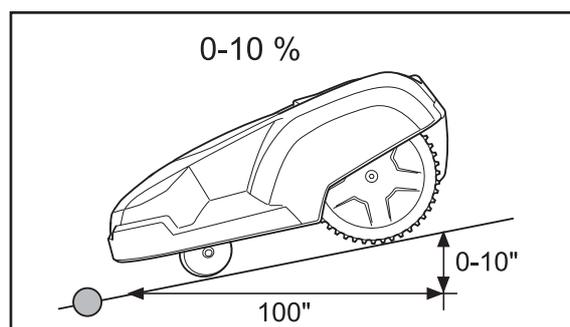
Le câble périphérique ne doit pas être posé en travers d'une pente d'une inclinaison supérieure à 10 %. Automower® aurait du mal à tourner et risquerait de s'immobiliser. Le risque est particulièrement important par temps humide dans la mesure où les roues risquent de déraiser dans l'herbe mouillée.
