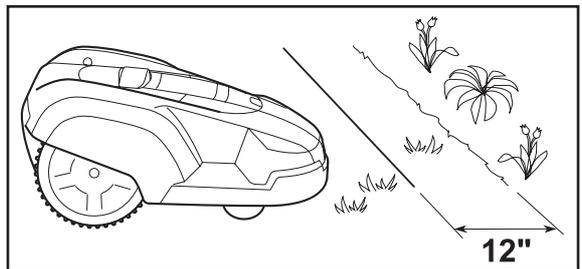
Si la zone de travail est contiguë à une allée au même niveau que la pelouse, il est possible de laisser Automower® s'avancer quelque peu sur cette allée. Le câble périphérique doit être placé à 10 cm (4") du bord de l'allée.
