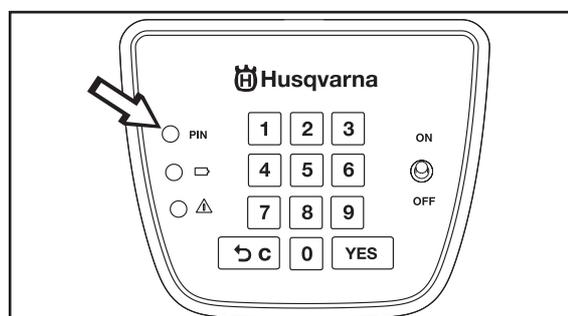
Une fois le code PIN sélectionné, la tondeuse et le générateur/chargeur sont connectés l'un à l'autre et la tondeuse peut être utilisée.
