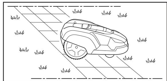
Remarque ! Automower® ne peut pas traverser une allée en gravillons. Risque d'endommagement des lames !
