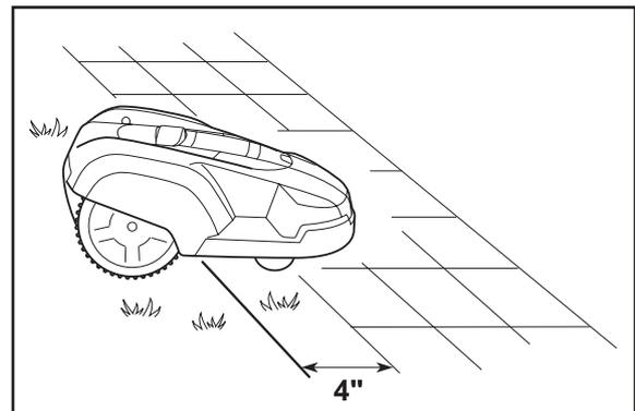
Si la zone de travail est divisée par une allée dallée de même niveau que la pelouse, il est possible de laisser Automower® traverser l'allée. Le câble périphérique peut très bien être posé sous les dalles. Il est également possible de loger le câble périphérique dans les rainures entre les dalles.
