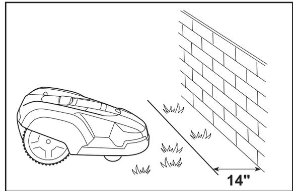
Si la zone de travail est délimitée par un petit fossé, une plate-bande par exemple, ou une petite surélévation, un rebord en pierres basses par exemple (3 à 5 cm) (1" - 2"), le câble périphérique doit être placé à 30 cm (12") à l'intérieur de la zone de travail. De cette manière, les roues ne risquent pas de basculer dans le fossé ou de monter sur le rebord.
