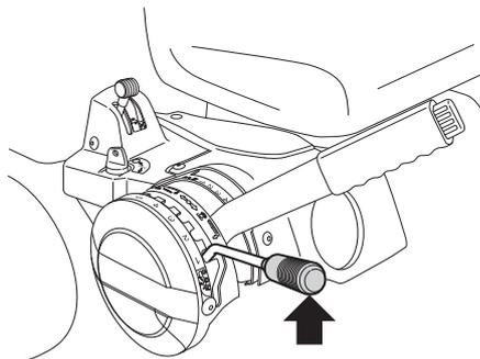
Pour obtenir une hauteur de coupe homogène, il est important que la pression soit identique dans les deux roues avant 60 kPa/0,6 bar/8,5 PSI.
