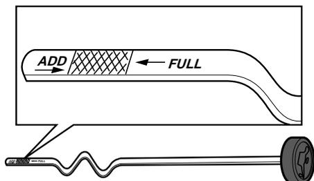
Le remplissage d'huile s'effectue dans le trou de la jauge. Remplir d'huile lentement.
