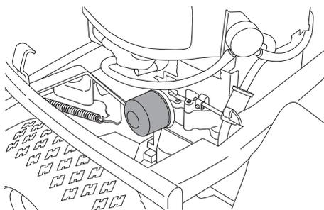
Graisser légèrement le joint en caoutchouc du filtre à huile neuf avec de l'huile neuve. Monter le filtre à huile en le visant dans le sens des aiguilles d'une montre. Visser à la main jusqu'à ce que le joint en caoutchouc soit bien aligné. Serrer d'un demi tour de plus.
