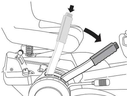
Le levier peut également être utilisé pour régler provisoirement la hauteur de la coupe, par exemple dans le cas d'un léger renflement de la pelouse.
