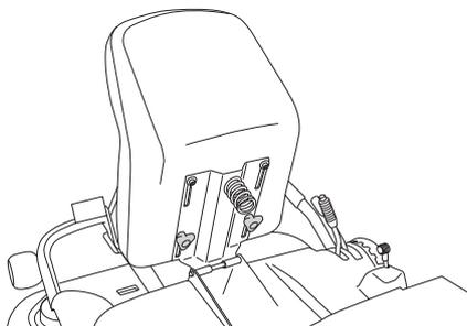
Le siège peut également être ajusté longitudinalement.
