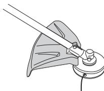
S'assurer que la protection est intacte et qu'elle ne présente pas de fissures. Remplacer la protection si elle a subi des coups ou si elle présente des fissures.
