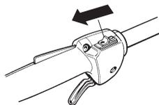
**Starter:** Laisser la commande du starter en position de fonctionnement.
