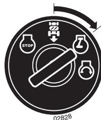
Положение двигателя "ON" (обычная работа)
