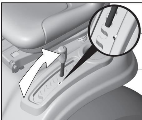
**RU 6. Быстрый подъем/опускание режущего блока**
