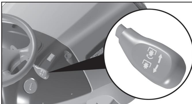
**RU 5. Подключение/отключение режущего блока.**
