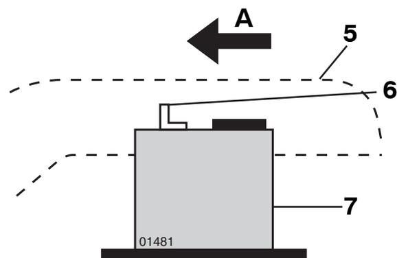
**(RU) ⚠ ПРЕДУПРЕЖДЕНИЕ:** Для того, чтобы предупредить образование искр в результате случайного заземления, необходимо вначале подсоединить положительный полюс.
