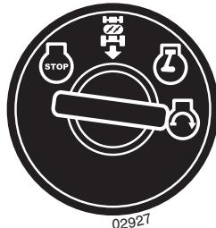
(SI) Obrnite kontaktni kljuc v položaj "START" position.
