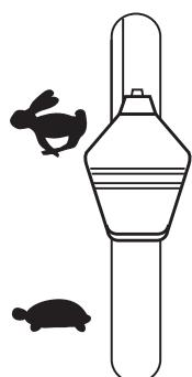
**(CZ)** Teplý motor: Nastavte páčku plynu do střední polohy - plný plyn. (👉).
