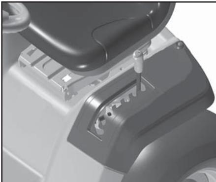
**(RU) 6. Быстрый подъем/опускание режущего блока**
