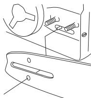
Spann kedjan genom att med hjälp av kombinyckeln skruva kedjespännerskruven medurs.
