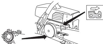
Monter koplingsdekselet og lokalisér kjedestrammertappen i hullet i sverdet. Kontroller at kjedets drivlenker passer på drivhjulet og at kjedet ligger riktig i sverdsporet. Trekk til sverdmutterne med fingrene.
