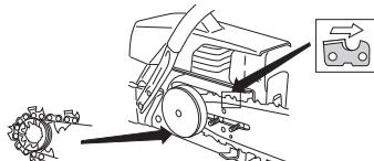
Montér koblingsdækslet, og lokalisér kædestrammertappen i sværdets udtag. Kontrollér, at kædens drivled passer til kædedrivhjulet, og at kæden
