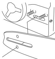
Spænd kæden ved at bruge kombinøglen til at skru kædestrammerskruen med uret. Kæden skal strammes til, så den ikke hænger slapt ned på sværdets underside.
