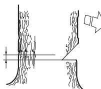
Placer barkstøten (hvis den er monteret) bag brudpunktet. Sav med fuld gas, og før savkæden/sværdet langsomt ind i træet. Vær opmærksom på, om træet bevæger sig i modsat retning i forhold til den valgte faldretning. Sæt en fældekile i eller et brækjern i fældesnittet, så snart snitdybden tillader det.
