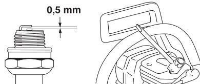
Notera! Använd alltid rekommenderad tändstiftstyp! Felaktigt tändstift kan förstöra kolv/cylinder. Se till att tändstiftet har s.k. radioavstörning.
