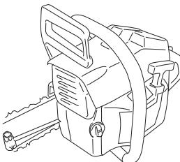
Ketjun kireys on oikea, kun se ei roiku löysällä terälevyn alapuolella ja liikkuu kevyesti käsin pyöritettäessä. Kiristä terämutterit yhdistelmäävaimella pitäen samalla terälevyn kärkeä ylhäällä.
