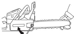
Uuden ketjun kireys on tarkastettava usein ketjun sisäänaajan aikana. Tarkasta ketjun kireys säännöllisesti. Oikein kiristetty ketju takaa hyvän leikkuutehon ja pitkän kestoiän.
