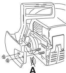
Montér sværdet over sværdboltene. Placér sværdet i dets bagerste stilling. Placér kæden over kædedrivhjulet og i sværdsporet. Begynd på sværdets overside. Kontrollér, at øggen på skæreleddene er peger fremad på sværdets overside.
