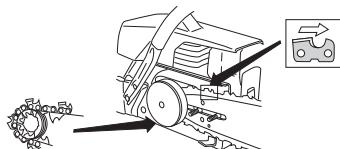
Asenna kytkinkotelo ja katso ketjun kiristystapin paikka terälevyn lovesta. Tarkasta, että ketjun vetolenkit sopivat ketjupyörään ja että ketju on oikein terälevyn ohjausurassa. Kiristä terämutterit sormin.
