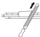
Använd flatfilen för att fila bort överskottet på den överstjutande delen av underställningsklacken. Underställningen är korrekt då inget motstånd känns när du drar filen över mallen.
