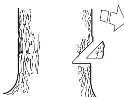
Retningsnittdybden skal være 1/4 af stammens diameter, og vinklen mellem over- og undersnit skal være mindst 45°.
