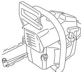
Kedjan är korrekt spänd när den inte hänger slak på svärdets undersida och fortfarande kan dras runt lätt för hand. Drag fast svärdsmuttrarna med kombinyckeln samtidigt som svärdsspetsen hålls upp.
