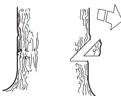
Riktskärsdjupet skall vara  $1/4$  av stamdiometern och vinkeln mellan över- och underskär minst  $45^\circ$ .
