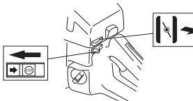
Hvis maskinen har dekompressjonsventil (A): Trykk inn ventilen for å redusere trykket i cylinderen, dette for å gjøre maskinen lettere å starte. Dekompressjonsventilen bør alltid brukes ved start. Når maskinen har startet går ventilen automatisk til utgangsstilling.
