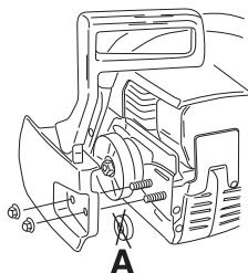
Asenna terälevy takimaiseen teräpultteihin. Aseta terälevy takimaiseen asentoonsa. Aseta ketju ketjupyörälle ja terälevyn ohjausuraan. Aloita terälevyn yläpuolelta. Tarkasta, että hammaslenkkien teräsärmät ovat eteenpäin terälevyn yläpuolella.
