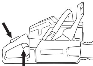
Tryck in chokereglaget omedelbart när motorn tänder och gör förynade startförsök tills motorn startar. När motorn startar, ge snabb fullgas och startgasen kopplas automatiskt ur.
