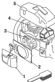
Puhdista jäähditysjärjestelmä harjalla kerran viikossa, vaikeammassa käytössä useammin. Likainen tai tukkeammat jäähditysjärjestelmä johtaa koneen ylikuumenemiseen, josta on seurauksena sylinterin ja mänän vaurioituminen.
