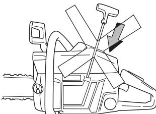
Återställ kedjebromsen genom att föra kastskyddet mot handtagsbygeln. Motorsågen är härmed klar för användning.
