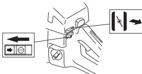
Om maskinen är utrustad med en dekompressionsventil (A): Tryck in ventilen för att minska trycket i cylindern, detta för att underlätta starten av maskinen.
