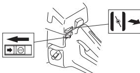
Hvis maskinen er forsynet med en dekompresionsventil (A): Tryk ventilen ind for at mindske trykket i cylinderen, så maskinen starter lettere. Dekompresionsventilen bør altid bruges ved start. Når maskinen er startet, vender ventilen automatisk tilbage til udgangsstillingen.
