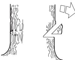
Dybden på styreskåret skal være 1/4 av stammens diameter og vinkelen mellom over- og underskjær minst 45°.
