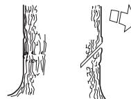
Sav derefter undersnittet, så det afsluttes præcis, hvor oversnittet slutter.
