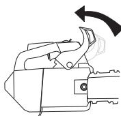
Skru ut sverdmutteren og demonter koplingsdekselet (kjedebremsen). Fjern transportbeskyttelsen.
