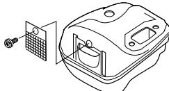
Lyddæmperen er beregnet til at dæmpe lydniveauet og til at lede udstødningsgasserne væk fra brugeren. Udstødningsgasserne er varme og kan indeholde gnister, som kan forårsage brand, hvis udstødningsgasserne rettes mod et tørt og brændbart materiale.
