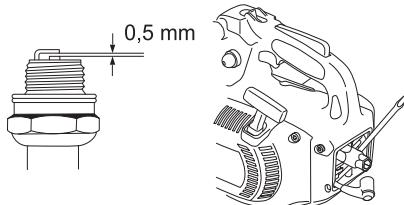
Bemerk! Bruk alltid anbefalt type tennplugg! Feil tennplugg kan ødelegge stempel/sylinder. Påse at tennpluggen har såkalt radiostøyfilter.
