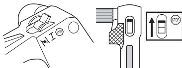
Motoren standses ved at anbringe stopknappen i stopstilling.
