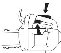
Notera! Återställ kedjebromsen genom att föra kastskyddet mot handtagsbygeln. Motorsågen är härmed klar för användning.
