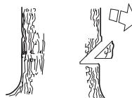
Dybden på styreskåret skal være 1/4 av stammens diameter og vinkelen mellom over- og underskjær minst 45°.
