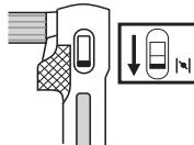
**Brennstoffpumpe:** Trykk på brennstoffpumpens gummirulle gjenntatte ganger til brennstoff begynner å fylle blæren. Blæren behøver ikke å fylles helt.
