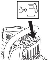
**ADVARSEL!** Brennstoff og brennstoffdamp er meget brannfarlig. Vær forsiktig ved håndtering av brennstoff og kjedeolje. Husk brann-, eksplosjons- og innåndingsfare.
