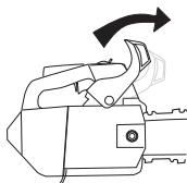
**Tenning; choke:** Skyv regulatoren til bakerste stilling.
