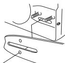
Spænd kæden ved at bruge kombinøglen til at skru kædestrammerskruen med uret. Kæden skal strammes til, så den ikke hænger slapt ned på sværdets underside. Se anvisningerne i afsnittet Stramning af savkæden.
