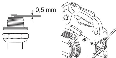
Notera! Använd alltid rekommenderad tändstiftstyp! Felaktigt tändstift kan förstöra kolv/cylinder. Se till att tändstiftet har s.k. radioavstörning.
