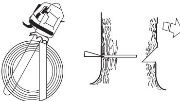
Kaatosauksen on päätyttävä samansuuntaisesti kaatolovilinjaan nähden, niin että niiden välin jää vähintään 1/10 rungon läpimitasta. Läpisyhämätonta rungon osaa kutsutaan pitopuksi.
