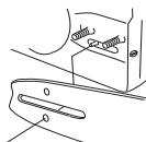
Spänn kedjan genom att med hjälp av kombinyckeln skruva kedjespännarskruven medurs. Se anvisningar under rubrik Sträckning av sågkedjan.
