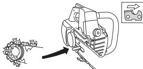
Tarkasta, että hammaslenkkien teräsärmät ovat eteenpäin terälevyn yläpuolella.
