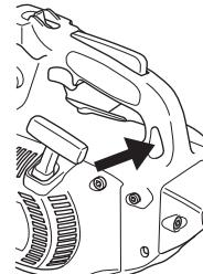
b) varaa sopivat karpit, joilla saha saadaan kiinnitettyä välillisesti (sis raksin avulla) ja suoraan (eli sahan kiinnityskohdasta) käyttäjän valjaisiin.
