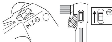
Motorn stannas genom att skjuta stoppkontakten till stoppläge.
