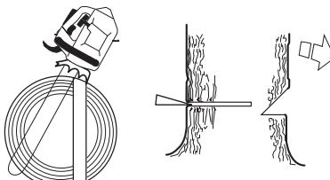
Fällskäret skall avslutas parallellt med riktskärslinjen så att avståndet mellan de båda är minst  $1/10$  av stamdiometern. Den icke genomsågade delen av stammen kallas brytmånen.
