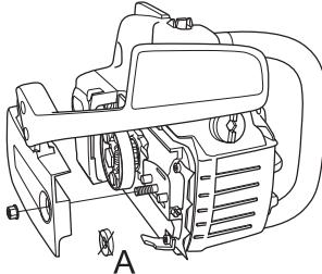
Montér sværdet over sværdboltene. Placér sværdet i dets bagerste stilling. Placér kæden over kædedrivhjulet og i sværdsporet. Begynd på sværdets overside.
