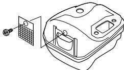
Ljuddämparen är utformad för att dämpa ljudnivån och för att leda avgaserna bort från användaren. Avgaserna är heta och kan innehålla gnistor vilka kan orsaka brand om avgaserna riktas mot ett torrt och brännbart material.
