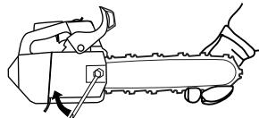
Uuden ketjun kireys on tarkastettava usein ketjun sisäänajon aikana. Tarkasta ketjun kireys säännöllisesti. Oikein kiristetty ketju takaa hyvän leikkutehon ja pitkän kestoisen.
