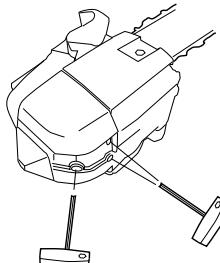
Noen lyddempere er utstyrt med et spesielt gnistfangernett. Hvis maskinen er utstyrt med en slik lyddemper, bør nettet rengjøres en gang i uken. Dette gjøres enklest med en stålborste. Et tilstoppet nett fører til at motoren går varm med alvorlig motorskade som følge.
