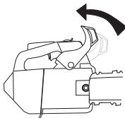
Ruuvaa terälevyn mutteri irti ja irrota kytkinkotelo (ketujarru). Poista kuljetussuoja.
