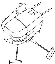
Visse lyddæmpere er udstyret med et specielt gnistfangernet. Hvis din maskine er udstyret med en sådan lyddæmper, bør nettet rengøres en gang om ugen. Dette gøres bedst med en stålbørste. Et tilstoppet net medfører, at motoren kører varm med alvorlig motorskade til følge.
