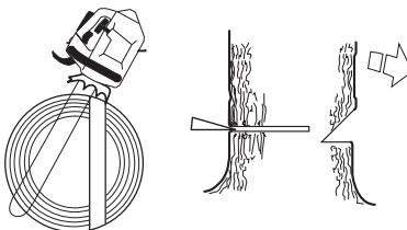
Fældesnittet skal afsluttes parallelt med retningssnitlinjen, så afstanden mellem de to er mindst 1/10 af stammens diameter. Den ikke gennemsavede del af stammen kaldes brudpunktet.
