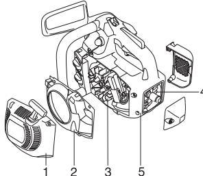
Rens kølesystemet med en børste en gang om ugen, under støvfylde forhold oftere. Et snavset eller tilstoppet kølesystem medfører overopvarmning af maskinen med skader på cylinderen og stemplet til følge.
