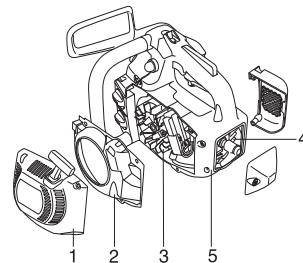
Rengjør kjølesystemet med en børste en gang i uken, ved vanskelige forhold oftere. Et tilmusset eller tett kjølesystem fører til at maskinen overopphetes, noe som forårsaker skader på sylinder og stempel.
