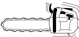
Kontrollera att avvibreringselementen är fast förankrade mellan motorenhet respektive handtagsenhet.
