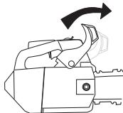
**Tändning; choke:** Skjut reglaget till sitt bakre läge.
