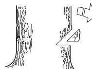
Retningssnittdybden skal være  $\frac{1}{4}$  af stammens diameter, og vinklen mellem over- og undersnit skal være mindst  $45^\circ$ .
