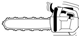
Kontroller at avvibreringselementene er fast forankret mellom motor- og håndtaksenhet.
