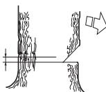
Sett i barkstøtten (hvis en slik er montert) bak brytekanten. Sag med full gass og før sagkjedet/sverdet sakte inn i treet. Vær på vakt mot at treet beveger seg i motsatt retning av det som er valgt som fallretning.
