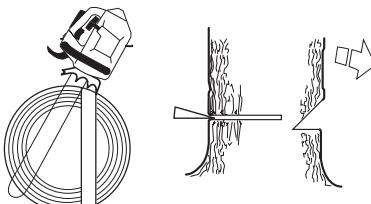
Hovedskåret skal avsluttes parallelt med styreskárlinjen slik at avstanden mellom dem er minst  $1/10$  av stammens diameter. Den delen av stammen som ikke er gjennomsagd, kalles brytekant.
