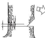
Sätt i barkstödet (om något är påmonterat) bakom brytmånen. Såga med fullgas och för sågkedjan/svärden sakt in i trädet. Var observant på om trädtoppen rör sig motsatt riktning till vald fallriktning.
