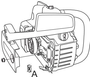
Asenna terälevy teräpultteihin. Aseta terälevy takimaiseen asentoonsa. Aseta ketju ketjupyörälle ja terälevyn ohjausurauaan. Aloita terälevyn yläpuoleltä.
