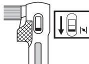
**Bränslepump:** Tryck på bränslepumpens gummiblåsa uppdelade gånger tills bränsle börjar fylla blåsan. Blåsan behöver ej fyllas helt.
