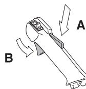
Kontroller at gassregulatoren er låst i tomgangsstilling når gassregulatorsperren er i sin utgangsposisjon.
