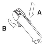
Kontrollér, at gasreguleringen er låst i tomgangsstilling, når gasreguleringslåsen befinner sig i udgangsstilling.
