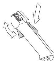
Se anvisningar under rubrik Start. Starta häcksaxen och ge full gas. Släpp gasreglaget och kontrollera att knivarna stannar och förblir stillastående. Om knivarna rör sig med gasreglaget i tomgångsläge skall förgasarens tomgång justeras. Se anvisningar under rubrik Underhåll.
