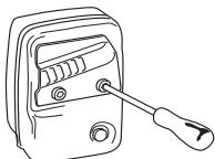
Är din maskins ljuddämpare utrustad med ett gnistfångarnät, skall detta rengöras regelbundet. Ett igaensatt nät leder till varmkörning av motorn med allvarlig motorskada som följd.
