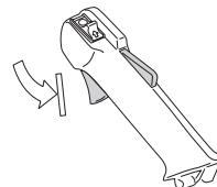
Tryck in gasreglagespärren och kontrollera att den återgår till sitt ursprungsläge när den släpps.
