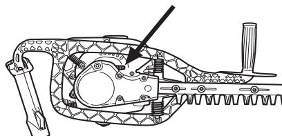
**BEMÆRK!** Gearet skal ikke fyldes helt med fedt. Fedtet udvides af den varme, som opstår, når maskinen kører. Hvis gearet var helt fyldt med fedt, er der risiko for ødelagte pakninger og fedtlækage.
