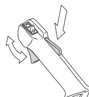
Se anvisninger under Start. Start hekksaksen og gi full gass. Slipp gassregulatoren og kontroller at knivene stanser og forblir stående stille. Hvis knivene beveger seg når gassregulatoren står i tomgangsstilling, må forgasserens tomgang kontrolleres. Se anvisninger under Vedlikehold.
