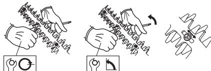
Vid korrekt justerade knivar skall det, mätt vid skruvarna, vara ett spel mellan knivarna på 0,2-0,4 mm.
