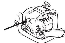
**OBS!** Använd alltid rekommenderad tändstiftstyp! Felaktigt tändstift kan förstöra kolv/cylinder. Se till att tändstiftet har s.k. radioavstörning.
