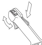
Se anvisningerne under overskriften Start. Start hækkelipperen, og giv fuld gas. Slip gasreguleringen, og kontrollér, at knivene standser, og at de bliver stående stille. Hvis knivene beveger sig med gasreguleringen i tomgangsstilling, skal karburatorens tomgangsindstilling justeres. Se anvisningerne under overskriften Vedligeholdelse.
