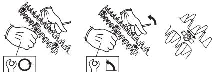
Ved korrekt justerte kniver skal det, målt ved skruene, være en klarlag mellom knivene på 0,2-0,4 mm.
