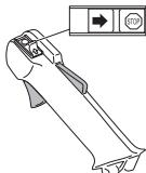
Starta motorn och kontrollera att motorn stängs av när stoppkontakten förs till stoppläget.
