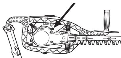
**HUOM!** Vaihdetta ei saa täyttää aivan täyneen rasvalla. Rasva laajenee koneen käytön aikana kehittyvän lämmön vaikutuksesta. Jos vaihde on aivan täynä rasvaa, on olemassa tiivisteiden vaurioitumisen ja rasvavuodon vaara.
