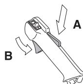
Kontrollera att gasreglaget är låst i tomgångsläge när gasreglagespärren är i sitt ursprungsläge.
