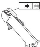
**HUOM!** Pysäytyskosketin palautuu automaattisesti käynnistysasentoon. Sen vuoksi, tähattoman käynnistyksen estämiseksi, sytytystulpan suojuus on aina irrotettava sytytystulpasta asennuksen, tarkastuksen ja tai huollon ajaksi.
