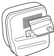
På ljuddämpare utan katalysator bör nätet rengöras och eventuellt bytas en gång per vecka. På katalysatorljuddämpare skall nätet kontrolleras och eventuellt rengöras en gång per månad. **Vid ev. skador på nätet skall detta bytas.** Om nätet ofta är igensatt, kan detta vara ett tecken på att katalysatorns funktion är nedslatt. Kontakta din återförsäljare för kontroll. Med ett igensatt nät överhettas maskinen med skador på cylinder och kolv som följd. Se även anvisningar under rubrik Underhåll.
