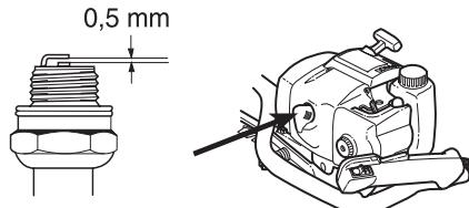
**OBS!** Bruk alltid anbefalt type tennplugg! Feil tennplugg kan ødelegge stempel/sylinder. Påse at tennpluggen har såkalt radiostøtfILTER.
