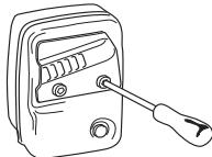
Jos koneesi äänenvaimennin on varustettu kipinänsammutsverkolla, on myös se puhdistettava säännöllisesti. Tukkeutunut verkkohaikeuttaa moottorin kuumentumisen, mistä seuraa vakava moottorivaurio.
