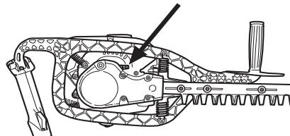
**OBS!** Växeln ska ej fyllas helt med fett. Fettet expanderar av den värme som uppstår när maskinen körs. Skulle växeln vara helt fylld med fett finns det risk för förstörda tätningar och fettläckage.
