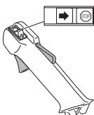
**BEMÆRK!** Stopkontakten skifter automatisk til startposition. For at undgå utsiglet start skal tændhætten derfor altid tages af tændrøret ved montering, kontrol og/eller vedligeholdelse.
