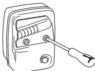
Hvis lyddemperen i maskinen er utstyrt med gnistfangernett, må dette rengjøres regelmessig. Et tilstoppet nett fører til at motoren går varm med alvorlig motorskade som følge.
