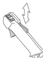
Kontroller at gassregulatoren og gassregulatorsperren går lett og at returfjærssystemet fungerer.
