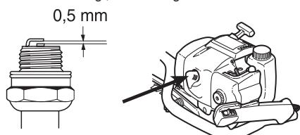
**BEMÆRK!** Brug altid anbefalet tændrørtypen! Forkert tændrør kan ødelægge stempel/cylinder. Kontrollér, at tændrøret har såkaldt radiostøjdæmpning.
