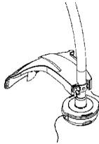
S'assurer que la protection est intacte et qu'elle ne présente pas de fissures. Remplacer la protection si elle a subi des coups ou si elle présente des fissures. Toujours utiliser la protection recommandée prévue pour l'équipement de coupe en question. Voir Caractéristiques techniques.
