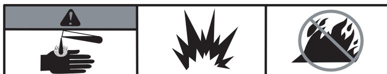
L'acide de batterie est corrosif, explosif et inflammable
