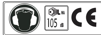
Émissions sonores dans le milieu environnant conformes à la directive de l'Union européenne. Les émissions de la machine sont indiquées à la section CARACTÉRISTIQUES TECHNIQUES et sur les autocollants.
