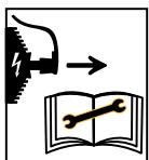
Le contrôle et/ou l'entretien doivent être effectués avec le moteur à l'arrêt et l'étrier du frein moteur relâché.
