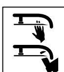
Steek geen hand of voet in de uitwerpopening zonder dat u eerst de ontstekingskabel hebt verwijderd.
