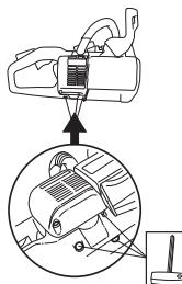
Visse lyddæmperer er udstyret med et specielt gnistfangernet. Hvis din maskine er udstyret med en sådan lyddæmper, bør nettet rengøres en gang om ugen. Dette gøres bedst med en stålbørste. Et tilstoppet net medfører, at motoren kører varm med alvorlig motorskade til følge.
