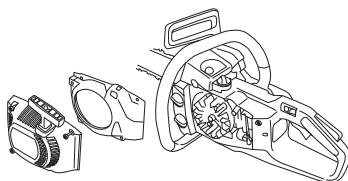
Rens kølesystemet med en børste en gang om ugen, under støvfylde forhold oftere. Et snavset eller tilstoppet kølesystem medfører overopvarmning af maskinen med skader på cylinderen og stemplet til følge.
