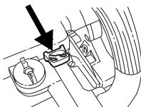
**Bränslepump:** Tryck på bränslepumpens gummiblåsa uppriade gånger tills bränsle börjar fylla blåsan. Blåsan behöver ej fyllas helt.
