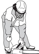
Skv regulatoren til startgasstilling når motoren tennen og foreta gjentatte forsøk til motoren starter. Når motoren starter gir du raskt full gass, og startgassen koples ut automatisk.
