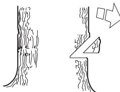
Dybden på styreskåret skal være 1/4 av stammens diameter og vinkelen mellom over- og underskjær minst 45°.
