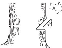
Riktskärsdjupet skall vara  $\frac{1}{4}$  av stamdiametern och vinkeln mellan över- och underskär minst  $45^\circ$ .
