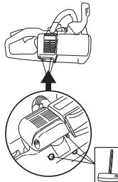
Noen lyddempere er utstyrt med et spesielt gnistfangernett. Hvis maskinen er utstyrt med en slik lyddemper, bør nettet rengjøres en gang i uken. Dette gjøres enklast med en stålborste. Et tilstoppet nett fører til at motoren går varm med alvorlig motorskade som følge.
