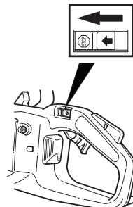
Motorn stannas genom att skjuta stoppkontakten till stopläge.
