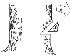
Retningssnitdybden skal være  $\frac{1}{4}$  af stammens diameter, og vinklen mellem over- og undersnit skal være mindst  $45^\circ$ .
