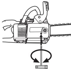
Ketjun kireys on oikea, kun se ei roiku löysällä terälevyn alapuolella ja liikkuu kevyesti käsin pyöritettäessä. Kiristä terämitterit yhdistelmäävaimella pitäen samalla terälevyn kärkeä ylhäällä.
