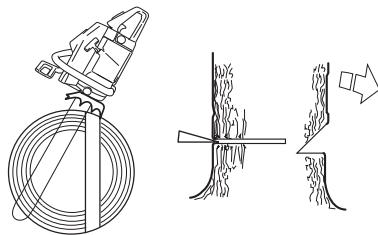
Hovedskåret skal avsluttes parallelt med styreskårlinjen slik at avstanden mellom dem er minst 1/10 av stammens diameter. Den delen av stammen som ikke er gjennomsagd, kalles brytekant.
