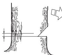
Sett i barkstøtten (hvis en slik er montert) bak brytekanten. Sag med full gass og før sagkjedet/sverdet sakte inn i treet. Vær på vakt mot at treet beveger seg i motsatt retning av det som er valgt som fallretning. Sett en fellekile eller brytejern i hovedskåret så snart skjæredybden tillater det.
