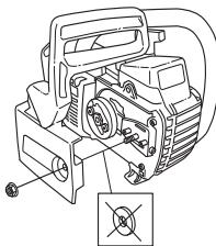
Montér sværdet over sværboltene. Placér sværdet i dets bagerste stilling. Placér kæden over kædedrivhjulet og i sværdsporet. Begynd på sværdets overside.
