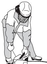
Työnnä säädin käynnistysasentoon, kun moottori sytyy ja yrität uudelleen kunnes moottori käynnisty. Kun moottori käynnisty, anna täyskaasu, jolloin käynnistyskaasu kytkeytyy automaatisesti pois.
