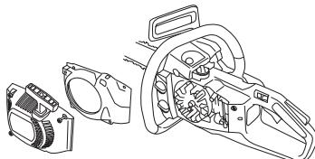
Rengjør kjølesystemet med en børste en gang i uken, ved vanskelige forhold oftere. Et tilsmusset eller tett kjølesystem fører til at maskinen overoppheves, noe som forårsaker skader på sylinder og stempel.
