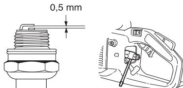
Notera! Använd alltid rekommenderad tändstiftstyp! Felaktigt tändstift kan förstöra kolv/cylinder. Se till att tändstiften har s.k. radioavstörning.
