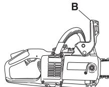
För kastskyddet fram och åter för att kontrollera att det går lätt samt att det är stabilt förankrat vid dess led i kopplingskåpan.
