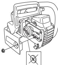
Asenna terälevy teräpultteihin. Aseta terälevy takimaiseen asentoonsa. Aseta ketju ketjupyörälle ja terälevyn ohjausaraan. Aloita terälevyn yläpuolella.
