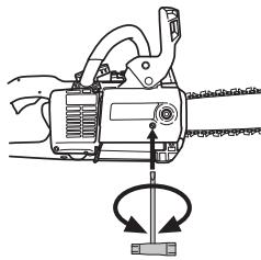
Kedjan är korrekt spänd när den inte hänger slak på svärdets undersida och fortfarande kan dras runt lätt för hand. Drag fast svärdsmuttrarna med kombinyckeln samtidigt som svärdspetsen hålls upp.
