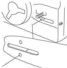
Kiristä ketju kiertämällä ketjun kiristysruuvia yhdistelmäävaimella myötäpäivään. Ketjua on kiristettävä sen verran, ettei se roiku löysällä terälevyn alapuolella.
