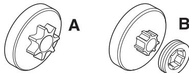
Kontroller slitasjenivået på kjededrivhjulet regelmessig. Skift det hvis det er unormalt slitt. Kjededrivhjul skal skiftes hver gang sagkjedet skiftes.
