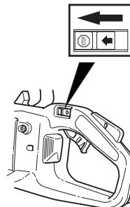
Motoren standses ved at anbringe stopknappen i stopstilling.
