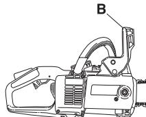
Siirrä takapotkusuojusta edestakaisin tarkastaaksesi, että se liikkuu kevyesti ja että se on tukevasti kiinni nivelessään kytkinkotelossa.
