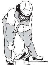
Sæt grebet i startgasstilling, når motoren tænder, og forsøg igen, indtil motoren starter. Når motoren starter, gives hurtig fuld gas og startgassen kobles automatisk fra.
