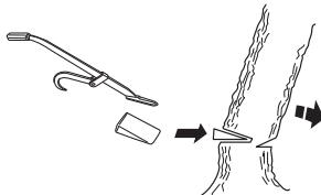
Vi anbefaler bruk av en sverdlengde som er større enn trees diameter, slik at hoved- og styreskår kan utføres med et såkalt "enkelt sageskår". Se anvisninger under overskriften Tekniske data ang. hvilke sverdlengder som anbefales for din motorsagsmodell.
