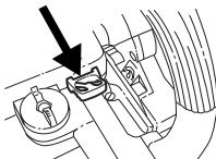
**Brændstofpumpe:** Tryk flere gange på brændstofpumpens gummiblære, indtil blæren fyldes
