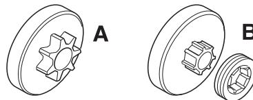
Tarkasta säännöllisesti ketjupyörän kuluneisuus. Vaihda, jos se on epätavallisen kulunut. Ketjupyörä on vaihdettava aina teräketjun vaihdon yhteydessä.
