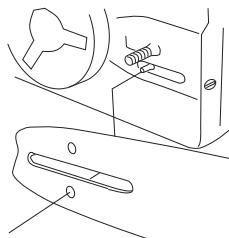
Spän kedjan genom att med hjälp av kombinyckeln skruva kedjespännaarskruven medurs. Se anvisningar under rubrik Sträckning av sågkedjan.
