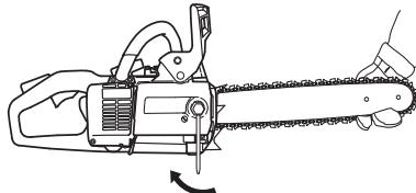
Uuden ketjun kireys on tarkastettava usein ketjun sisäänajon aikana. Tarkasta ketjun kireys säännöllisesti. Oikein kiristetty ketju takaa hyvän leikkuutehon ja pitkän kestoisen.
