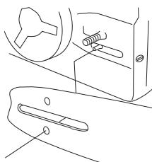
Spænd kæden ved at bruge kombinøglen til at skruke kædestrammerskruen med uret. Kæden skal strammes til, så den ikke hænger slapt ned på sværdets underside. Se anvisningerne i afsnittet Stramning af savkæden.
