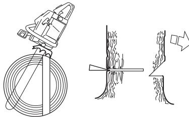
Fældesnittet skal afsluttes parallelt med retningsnittlinjen, så afstanden mellem de to er mindst  $1/10$  af stammens diameter. Den ikke gennemsavede del af stammen kaldes brudpunktet.
