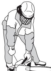
Skjut reglaget till sitt startgasläge när motorn tänds och gör förnyade försök tills motorn startar. När motorn startar, ge snabb fullgas och startgasen kopplas automatiskt ur.
