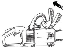
Ruuvaa terämitterit irti ja irrota kytikkoketelo (ketjujarru). Poista kuljetussuoja (A).
