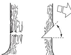
Ylä- ja alasahauksen kohtaamispistettä kutsutaan kaatolovilinjaksi. Kaatolovilinja on oltava tarkasti vaakasuorassa ja muodostettava samalla suora kulma (90°) valittuun kaatosuuntaan nähden.
