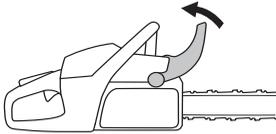
Déposer les écrous du guide-chaîne et le carter d'embrayage (frein de chaîne). Déposer la protection de transport (A).
