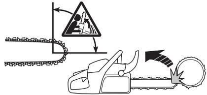
Le rebond se produit toujours dans le plan du guide-chaîne. En général, tronçonneuse et guide-chaîne sont relevés simultanément en direction de l'utilisateur.
