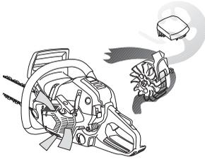
**IMPORTANT!** L'épuration centrifuge exige un entretien correct et continu de la machine. Nettoyer la prise d'air du lanceur, les ailettes du ventilateur, le compartiment du volant, le tuyau d'admission et le compartiment du carburateur.
