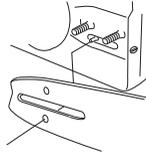
Tendre la chaîne en tournant le vis du tendeur de chaîne vers la droite à l'aide de la clé universelle. Tendre la chaîne jusqu'à ce qu'elle ne pende plus sous le guide. Voir les instructions à la section Tension de la chaîne.
