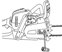
La chaîne est tendue correctement quand elle ne pend plus sous le guide et peut être avancée à la main sans difficulté. Serrer les écrous du guide à l'aide de la clé universelle tout en maintenant levé le pignon du guide.
