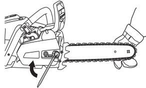
La tension d'une chaîne neuve doit être vérifiée fréquemment pendant son rodage. Vérifier régulièrement la tension. Une tension correcte est synonyme de bonne capacité de coupe et de longue durée de vie.
