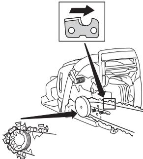
S'assurer que la face tranchante des dents est vers l'avant sur le dessus du guide.
