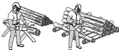
**Le tronç est couché à même le sol.** Il n'y a aucun risque de coincage de la chaîne ou de fendage de la pièce à scier. Par contre, il existe un risque important que la chaîne rencontre le sol après le sciage.
