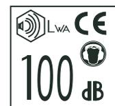
Émissions sonores dans le milieu environnant conformes à la directive de l'Union européenne. Les émissions de la machine sont indiquées à la section CARACTÉRISTIQUES TECHNIQUES et sur les autocollants.
