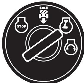
(SI) Neka se kontaktni kljuc okrene u položaj "ON" kada se motor pokrene. Gurnite rucicu za gas na zahtijevanu brzinu. Za rezanje, postavite je u puni gas.
