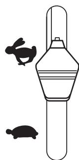
(CZ) Teply motor: Nastavte páčku plynu do střední polohy - plný plyn.
