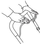
Der Bremsbügel darf niemals dauerhaft im Handgriff verankert sein, wenn die Maschine in Betrieb ist.
