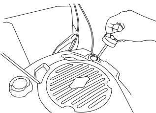
Der Öleinfülldeckel muss komplett heruntergeschraubt sein, um ein korrektes Bild des Ölstands bieten zu können.
