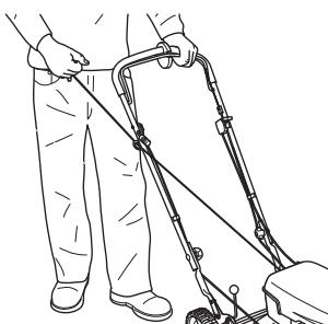
N.B.! Trek het starterkord niet volledig uit en laat de starthendel niet zomaar los wanneer het volledig uitgetrokken is. Dit kan tot beschadigingen van de machine leiden.
