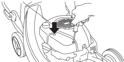
Verwijder het luchtfILTER en controleer of het heel is. Vervang door een nieuw luchtfILTER wanneer u merkt dat het gebreken vertoont.
