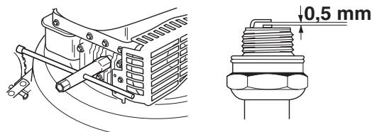
**ACHTUNG!** Stets den vom Hersteller empfohlenen Zündkerzentyp verwenden! Eine ungeeignete Zündkerze kann Kolben und Zylinder zerstören.
