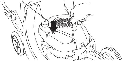
Luftfilter entfernen und prüfen, dass er intakt ist. Bei Defekten einen neuen Luftfilter einsetzen.
