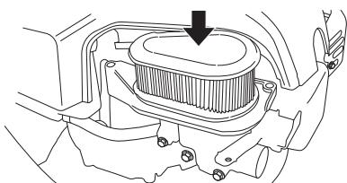
Maak het filter schoon door het tegen een vlakke ondergrond te kloppen. Gebruik nooit oplosmiddelen met petroleum, zoals bijv. fotogenen, of perslucht om het filter schoon te maken.
