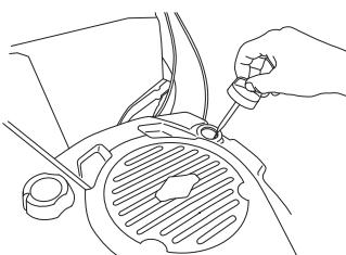
Het olievuldeksel moet helemaal ingeschroefd zijn om een correct beeld te geven van het oliepeil.
