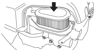
Filter reinigen, ihn dazu auf einer ebenen Fläche ausklopfen. Zur Reinigung des Filters niemals Druckluft oder Lösungsmittel mit Petroleum verwenden, z. B. Kerosin.
