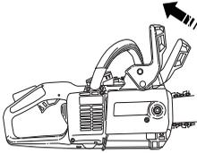
Die Schienenmutter lösen und den Kupplungsdeckel (Kettenbremse) abnehmen. Den Transportschutz (A) entfernen.
