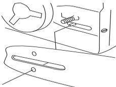
Die Kette durch Drehen der Kettenspannschraube im Uhrzeigersinn (einen Kombischlüssel verwenden) spannen. Die Kette soll gespannt werden, bis sie auf der Schienenunterseite nicht mehr durchhängt.
