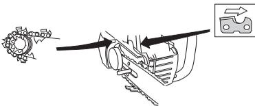
Darauf achten, dass die Schneiden der Sägezähne auf der Schienenoberseite nach vorn gerichtet sind.
