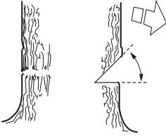
Der Schnittpunkt der beiden Schnitte wird als Kerbschnittlinie bezeichnet. Die Kerbschnittlinie soll exakt horizontal verlaufen und gleichzeitig einen rechten Winkel (90°) zur Fallrichtung bilden.
