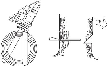
Der Fällschnitt soll parallel zur Kerbschnittlinie abschließen, so dass der Abstand zwischen beiden Schnitten mindestens 1/10 des Stammdurchmessers
