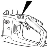
**Choke:** Den Chokehebel in Choke-Lage führen.
