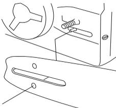
Verigo napnite s kombiniranim ključem tako, da obračate vijak za napenjanje verige v smeri urinega kazalca. Verigo napenjajte toliko časa, da ne bo več ohlapno visela s spodnjega roba meča.
