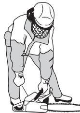
Den Regler in seine Startgasstellung schieben, wenn der Motor zündet, und neue Startversuche machen, bis der Motor startet. Wenn der Motor anspringt, schnell Vollgas geben und das Startgas schaltet sich automatisch aus.
