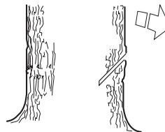
Dann einen Sägeschnitt von unten machen, der genau auf den Sägeschnitt von oben trifft.
