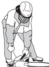
Ko vžigate motor, potisnite krmilnik v začetni položaj in nadaljujte s poskušanjem, dokler se motor ne zažene. Ko motor vžge, hitro prestavite na polni plin, da se samodejno sprosti hiter prosti tek.
