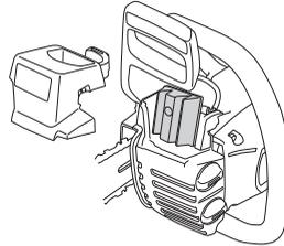
Eine gründlichere Reinigung erfolgt durch Auswaschen des Filters in Seifenwasser.
