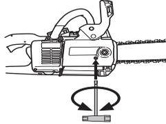
Die Kette ist richtig gespannt, wenn sie an der Schienenunterseite nicht durchhängt und noch leicht von Hand durchgezogen werden kann. Die Schienenspitze anheben und dabei gleichzeitig die Schienenmutter mit dem Kombischlüssel festschrauben.
