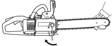
An einer neuen Kette muss die Kettenspannung oft kontrolliert werden, bis die Kette eingefahren ist. Die Kettenspannung regelmäßig prüfen. Mit einer richtig gespannten Kette wird eine gute Schnittleistung und eine lange Lebensdauer erzielt.
