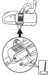
Bestimmte Schalldämpfer sind mit einem speziellen Funkenfangnetz ausgerüstet. Ist Ihr Gerät mit einem derartigen Schalldämpfer ausgestattet, so ist das Netz einmal wöchentlich zu säubern. Dies geschieht am besten mit einer Stahlbürste. Bei Verstopfung des Netzes läuft der Motor heiß, was schwere Motorschäden zur Folge haben kann.
