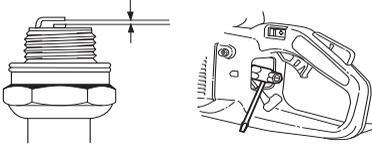
Hinweis! Stets den vom Hersteller empfohlenen Zündkerzentyp verwenden! Eine ungeeignete Zündkerze kann Kolben und Zylinder zerstören. Dafür sorgen, dass die Zündkerze eine sog. Funkenstörung hat.
