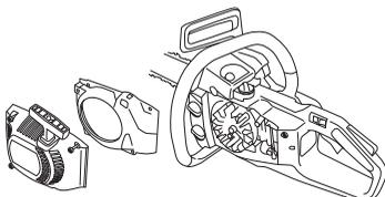
Hladilni sistem očistite s krtačo enkrat tedensko, v zahtevnih pogojih dela pa tudi pogosteje. Umazan ali zamašen hladilni sistem povzroča pregrevanje stroja, to pa poškoduje bat in cilindar.
