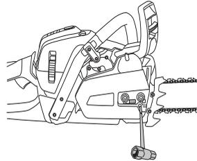
Die Kette ist richtig gespannt, wenn sie an der Schienenunterseite nicht durchhängt und noch leicht von Hand durchgezogen werden kann. Die Schienenspitze anheben und dabei gleichzeitig die Schienenmuttern mit dem Kombischlüssel festschrauben.
