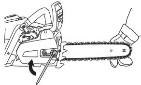
An einer neuen Kette muss die Kettenspannung oft kontrolliert werden, bis die Kette eingefahren ist. Die Kettenspannung regelmäßig prüfen. Mit einer richtig gespannten Kette wird eine gute Schnittleistung und eine lange Lebensdauer erzielt.
