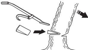
Wir empfehlen eine Führungsschiene Länge zu benutzen, die größer ist als der Stammdurchmesser, sodass Kerb- und Fällschnitt mit einem sog. einfachen Sägeschnitt ausgeführt werden können. Siehe die Anweisungen unter der Überschrift Technische Daten
