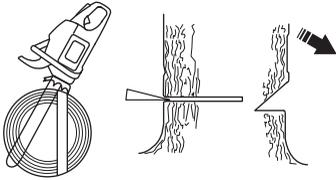
Der Fällschnitt soll parallel zur Kerbschnittlinie abschließen, so dass der Abstand zwischen beiden Schnitten mindestens  $\frac{1}{10}$  des Stammdurchmessers beträgt. Der nicht durchgesägte Teil des Stamm wird als Brechmaß bezeichnet.
