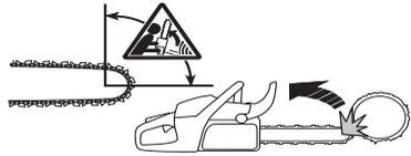
Ein Rückschlag ist immer in Richtung der Führungsschiene gerichtet. Am häufigsten erfolgt der Stoß von Motorsäge und Führungsschiene nach oben und nach hinten zum Anwender. Rückschläge erfolgen aber auch in andere Richtungen, je nachdem in welcher Stellung sich die Motorsäge in dem Augenblick befindet, in dem der Rückschlagbereich mit einem Gegenstand in Berührung kommt.
