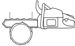
Es gibt Methoden zum Fällen von Bäumen, deren Stammdurchmesser größer ist als die Führungsschiene Länge. Bei solchen Methoden besteht große Gefahr, dass der Rückschlagbereich der Führungsschiene mit einem Gegenstand in Berührung kommt.
