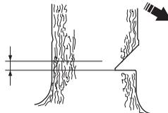
Die Rindenstütze (falls montiert) hinter dem Brechmaß ansetzen. Mit Vollgas sägen und mit der Sägekette/Führungsschiene langsam in den Baumstamm einschneiden. Aufpassen, ob sich der Baumstamm entgegenesetzt zur Fällrichtung bewegt. Einen Fällkeil
