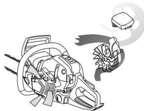
**POMEMBNO!** Učinkovitost centrifugalnega čiščenja je odvisna od rednega vzdrževanja in nege. Očistite dovod zraka v zaganjalnik, krila ventilatorja, prostor okrog ventilatorja, dovodno cev in komoro uplinjača.
