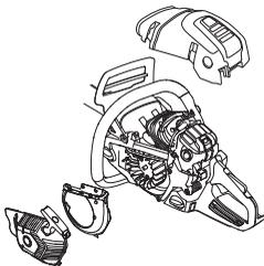
Hladilni sistem očistite s krtačo enkrat tedensko, v zahtevnih pogojih dela pa tudi pogosteje. Umazan ali zamašen hladilni sistem povzroča pregrevanje stroja, to pa poškoduje bat in cilinder.
