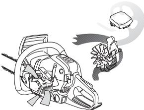
**WICHTIG!** Um die Funktion der Zentrifugalreinigung aufrecht zu erhalten, muss diese regelmäßig gewartet und gepflegt werden. Den Lufteinlass der Startvorrichtung, die Gebläseflügel des Schwungrads, den Raum um das Schwungrad, das Ansaugrohr und den Vergaserraum reinigen.
