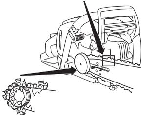
Darauf achten, dass die Schneiden der Sägezähne auf der Schienenoberseite nach vorn gerichtet sind.
