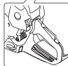
Da die Kettenbremse immer noch eingeschaltet ist, muss die Motordrehzahl so schnell wie möglich auf Leerlauf herunter, was durch ein schnelles Ausschalten der Gassperre erreicht wird. Dadurch vermeiden Sie
