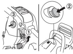
Prednji ročaj primite z levo roko. Desno nogo postavite na ustrezno mesto na spodnjem delu zadnjega ročaja in pritisnite napravo proti tlom.
