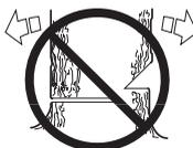
Vi anbefaler at bruge en sværdlængde, som er længere end træets diameter, som er længere end træets diameter, så fælde- og retningsnit kan udføres med et såkaldt "enkelt savsnit". Se kapitlet Tekniske data for at få oplysninger om, hvilke sværdlængder der anbefales til din motorsavsmodel.
