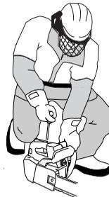
Trykk inn chokeregulatoren umiddelbart når motoren tenner, noe som høres ved en "poff"-lyd. Fortsett å dra med hurtige rykk i linen til motoren starter. Når motoren
