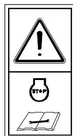
Couper le moteur avant d'effectuer des mesures de manitenance, de nettoyage et des réparations.
