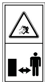
Ne pas se tenir dans la zone de travail de la machine. Contrôler que la surface herbeuse qui doit être traitée ne comporte ni pierres, branches ou tout autre débris. Ces objets pourraient être projetés par la machine et causer des blessures aux personnes et endommager la machine. Éviter de passer sur des allées de gravillons, etc.
