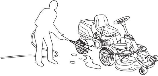
Ölreste lassen sich mit Kaltentfetter lösen. Eine dünne Schicht aufsprühen.
