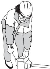
**REMARQUE!** Ne pas placer aucune partie du corps sur la surface marqué. Contact peut causer des brûlures à la peau ou des chocs électriques si le chapeau de bougie est defectueux. Toujours utiliser des gants. Ne jamais utiliser une machine dont le chapeau de bougie est defectueux.
