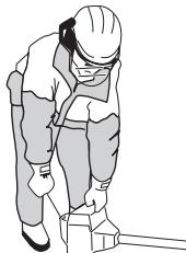
**N.B.!** Plaats geen enkel lichaamsdeel op het gemaakte vlak. Contact kan leiden tot brandwonden aan de huid of een elektrische schok wanneer het ontstekingsmechanisme kapot is. Gebruik altijd handschoenen. Gebruik nooit een machine met een kapot ontstekingsmechanisme.
