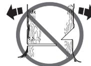
Vi anbefaler at bruge en sværdlængde, som er længere end træets diameter, så fælde- og retningsnit kan udføres med et såkaldt "enkelt savsnit". Se kapitlet Tekniske data for at få oplysninger om, hvilke sværdlængder der anbefales til din motorsavsmodel.
