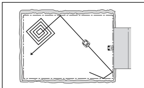
La tonte en mode carré désigne le fait que l'Automower® tondu en effectuant un parcours ayant la forme d'un carré. La tondeuse doit avoir fonctionné pendant plus de 6 heures avant que l'Automower® démarre une tonte en mode carré.
