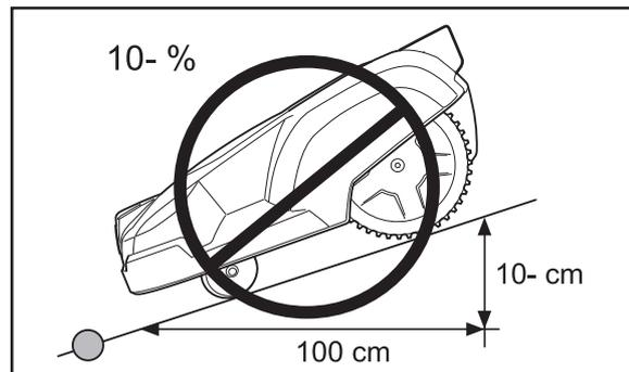
À l'intérieur de la zone de travail, l'Automower® peut tondre des zones en pente dont l'inclinaison peut atteindre 35 % (voir l'image). Les zones en pente ayant une inclinaison supérieure doivent être délimitées par le câble périphérique.
