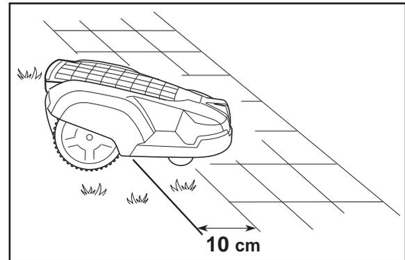
Si un sentier en dalles plates traverse la zone de travail et qu'il se trouve à la même hauteur que la pelouse, il est possible de laisser l'Automower® passer sur le sentier. Il peut être avantageux de poser le câble périphérique sous les dalles. Le câble périphérique peut aussi être posé dans le joint entre les dalles.
