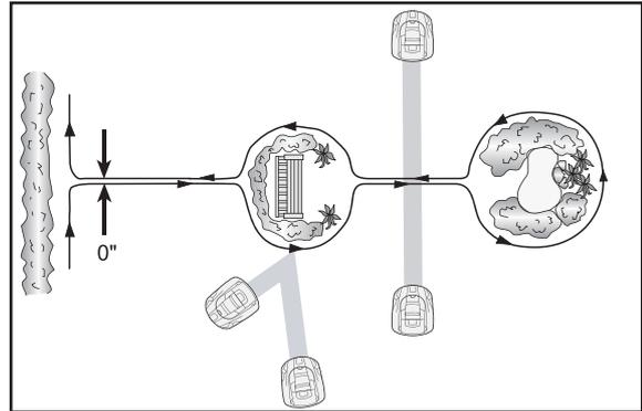
S'il y a des obstacles qui résistent aux collisions, par exemple, des arbres ou des arbustes dont la hauteur dépasse 15 cm, il n'est pas nécessaire de les délimiter à l'aide du câble périphérique. L'Automower® changera de direction quand elle heurtera ce type d'obstacle.
