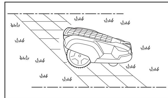
Remarque : L'Automower® ne doit jamais passer sur un sentier en gravier ou en matériau semblable, car ce type de matériau peut endommager les couteaux.
