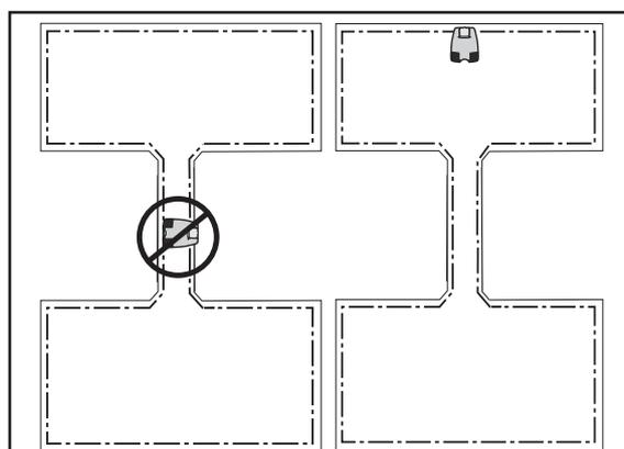
Placez la station de charge de façon que la tondeuse ne puisse pas s'approcher à moins de 3 m derrière la station de charge (par exemple, sur une pointe étroite). Si vous ne suivez pas cette directive, il sera plus difficile pour la tondeuse de trouver la station de charge.
