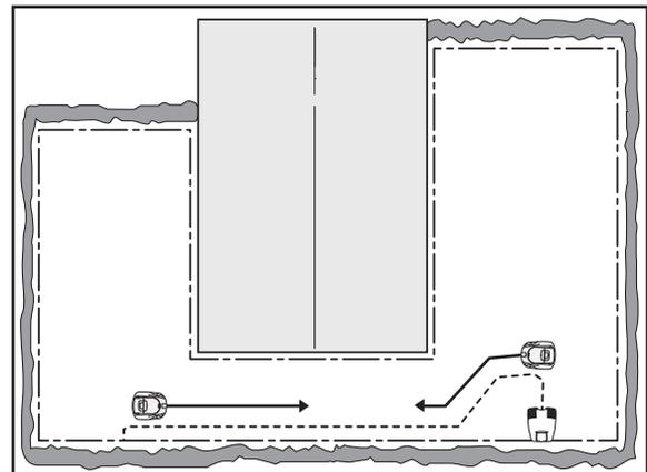
La même distance minimale (30 cm) doit séparer le câble guide et le câble guide dans le passage.
