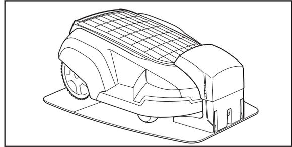
Vous obtiendrez un bon contact si les deux contacts de charge de la tondeuse touchent au centre des plaques de contact de la station de charge.
