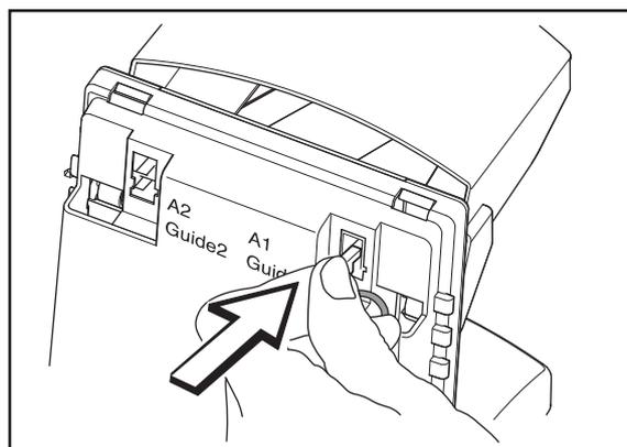
7. Remettez le couvercle sur la station de charge. Assurez que les trois protubérances de la station de charge sont emboîtées dans les bons trous du couvercle.
