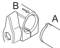
Skub monteringsdelen ind i koblingsstykket, indtil monteringsdelen klikker på plads.
