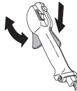
Se anvisningar under rubrik Start. Starta maskinen och ge full gas. Släpp gasreglaget och kontrollera att skärutrustningen stannar och att den förblir stillastående.
