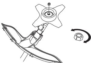
Låsemutterens nylonlåsing må ikke være så slitt at den kan skrus med fingrene. Låsinga må holde minst 1,5 Nm. Mutteren må skiftes etter at den har vært skrudd på ca. 10 ganger.
