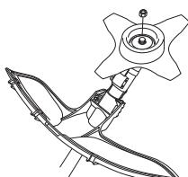
Vid montering, drag åt muttern mot skärutrustningens rotationsriktning. Vid demontering, lossa muttern i skärutrustningens rotationsriktning. (OBS! Muttern är vänsterfärgad.) Drag åt muttern med klingmutternyckeln.
