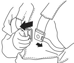
Kontrollera att selens remmar är rätt placerade. När seLEN och maskinen är justerade, kontrollera att selens snabbutlösning fungerar.
