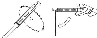
Tarkasta terälaitte vaurioiden ja halkeamien varalta. Vaurioitunut terälaitte on aina vaihdettava.
