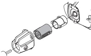
Kontroller regelmessig avvibreringselementene med tanke på materialsprekker og deformering.
