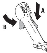
Kontrollér, at gasreguleringen er låst i tomgangsstilling, når gasreguleringslåsen befinner sig i udgangsstilling.
