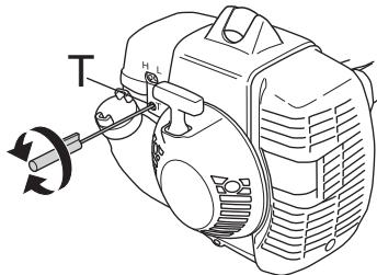
**VARNING!** Kan tomgångsvarvtalet ej justeras så att skärutrustningen står stilla, kontakta din återförsäljare/ serviceverkstad. Använd inte maskinen förrän den är korrekt inställt eller reparerad.
