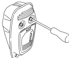
Hvis lyddemperen i maskinen er utstyrt med gnistfangernett, må dette rengjøres regelmessig. Et tilstoppet nett fører til at motoren går varm med alvorlig motorskade som følge.
