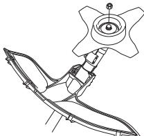
Trekk til mutteren mot skjæreutstyrets rotasjonsretning ved montering. Løsne mutteren i skjæreutstyrets rotasjonsretning ved demontering. (OBS! Mutteren er venstregjenget.) Trekk til mutteren med klingemutternøkkelen.
