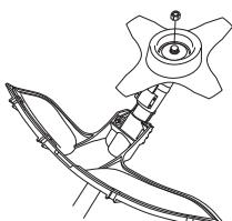
Spænd møtrikken mod skæreudstyrets rotationsretning ved montering. Løsn møtrikken i skæreudstyrets rotationsretning ved afdmontering. (OBS! Møtrikken har venstregevind.) Tilspænd møtrikken med klinkemøtriknøglen.
