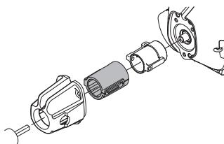
Kontrollera regelbundet avvibreringselementen efter materialsprickor och deformationer.
