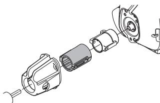
Kontrollér regelmæssigt vibrationsdæmpningselementerne for materialerrevner og deformationer
