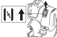
**Brændstofpumpe:** Tryk flere gange på brændstofpumpens gummiblære, indtil blæren fyldes
