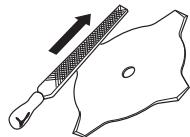
Sørg for, at udlægningen på savklingen er korrekt! Følg vores instruktioner, og brug det anbefaede udlæggerværktøj. En forkert udlagt savklinge øger risikoen for fastlæsning og kast samt skader på savklingen.
