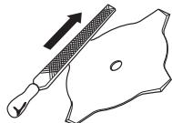
Håll korrekt skräntning på sågklingen! Följ våra instruktioner och använd rekommenderat skräntverktyg. En felaktigt skränt sågklinga ökar risken för fastlåsning och kast samt skador på sågklingen.
