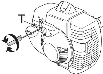
**ADVARSEL!** Hvis tomgangsomdrejningstallet ikke kan justeres, så skæreudstyret står stille, skal du kontakte din forhandler/dit serviceværksted. Brug ikke maskinen, før den er indstillet korrekt eller repareret.
