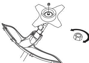
Låsmutterns nylonslängning får ej vara så sliten att den kan skruvas med fingrarna. Låsningen ska hålla minst 1,5 Nm. Muttern ska bytas efter det att den skruvats på ca 10 gånger.
