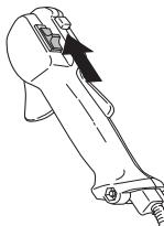
**HUOM!** Pysäytyskosketin palautuu automaattisesti käynnistysasentoon. Sen vuoksi, tahattoman käynnistyksen estämiseksi, sytytystulpan suojuus on aina irrotettava sytytystulpasta asennuksen, tarkastuksen ja/ tai huollon ajaksi.
