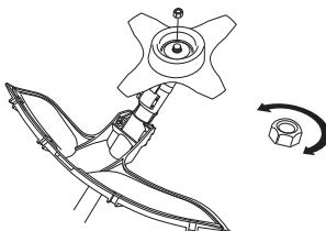
Lukitusmutterin nilonlukitus ei saa olla niin kulunut, etttä sitä voi ruuvata käsin. Lukituksen on kestettävä vähintään 1,5 Nm. Mutteri on vaihdettava, kun se on ruuvattu kiinni noin 10 kertaa.
