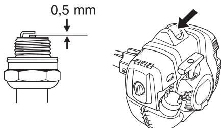
**BEMÆRK!** Brug altid anbefalet tændrørstype! Forkert tændrør kan ødelægge stempel/cylinder.
