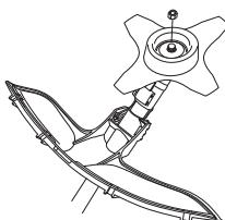
Asennettaessa, kiristä mutteri terälaitteen pyörimissuuntaa vastaan. Irrottaessa, irrota mutteri terälaitteen pyörimissuuntaan. (HUOM! Mutterissa on vasenkätinen kierre.) Kiristä mutteri terämutterilavaimella.
