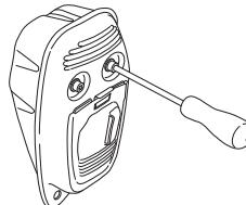
Er din maskines lyddæmper udstyret med et gnistfangernet, skal dette renses regelmæssigt. Et tilstoppet net medfører, at motoren kører varm med alvorlig motorskade til følge.
