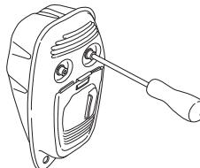
Jos koneesi äänenvaimennin on varustettu kipinänsammatusverkolla, on myös se puhdistettava säännöllisesti. Tukkeutunut verkko aiheuttaa moottorin kuumentemisen, mistä seuraa vakava moottorivaurio.
