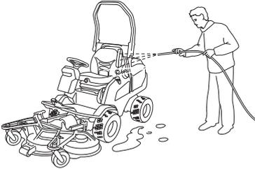
Ölreste lassen sich mit Kaltentfetter lösen. Eine dünne Schicht aufsprühen.
