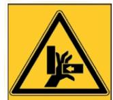
Quetschgefahr besteht zwischen den Hubarmen und der Bodenplatte.
