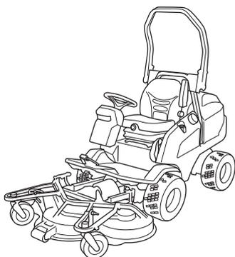
Der P 520D und P 525D ist mit Hydrauliklenkung und Hebevorrichtung ausgestattet.
