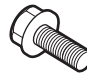
1/4 x 20 x 3/4 Ansatsbultar Skulderbolter Skulderbolte Olakeruuvit Parafuso com gola Κοχλίας με χιτώνιο
