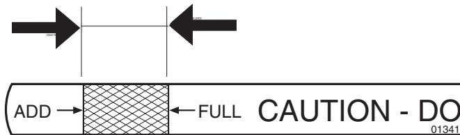
(CZ) Hladina oleja musí být mezi oběma značkami na měrce. Není-li tomu tak, dopřáte motorový olej SAE 30 až ke značce PLNA („FULL“). V zimě (při mrazivém počasí) použijte motorový olej SAE 5W-30.
