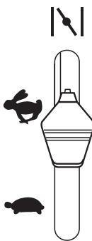
(RU) Разогретый двигатель: переместите регулятор газа на пол-пути в положение полного газа “”.
