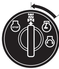
Положение двигателя "ON" (обычная работа)
