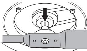
Montera fjäderbrickan och skruva fast bulten med bricka ordentligt. Bulten ska dras med ett moment av 45-60 Nm.
