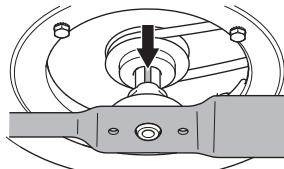
Monter fjederskiven, og spænd bolten og skiven korrekt. Bolten skal spændes med et tilspændingsmoment på 45-60 Nm.
