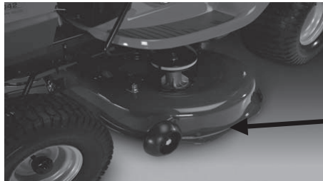
Coque d'unité de coupe estampée ci-dessous, NON renforcée
