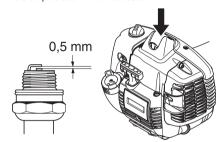
**REMARQUE!** Toujours utiliser le type de bougie recommandé! Une bougie incorrecte peut endommager le piston/le cylindre. S'assurer que la bougie est dotée d'un antiparasites.
